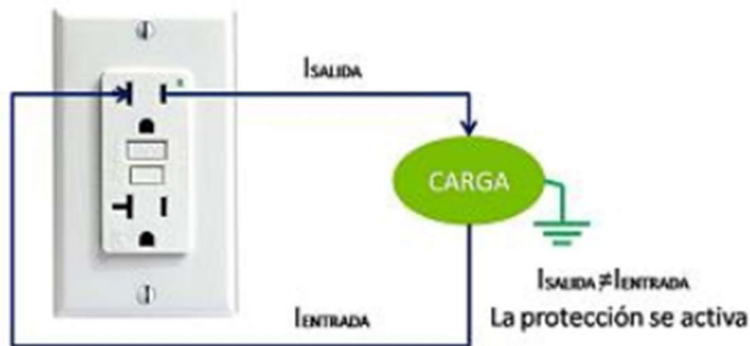
Ilustración 6.5.3 Contactos con protección a falla a tierra
