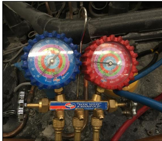
Figura 7.5 (Lectura de manómetros para llegar a 250 psi.)
