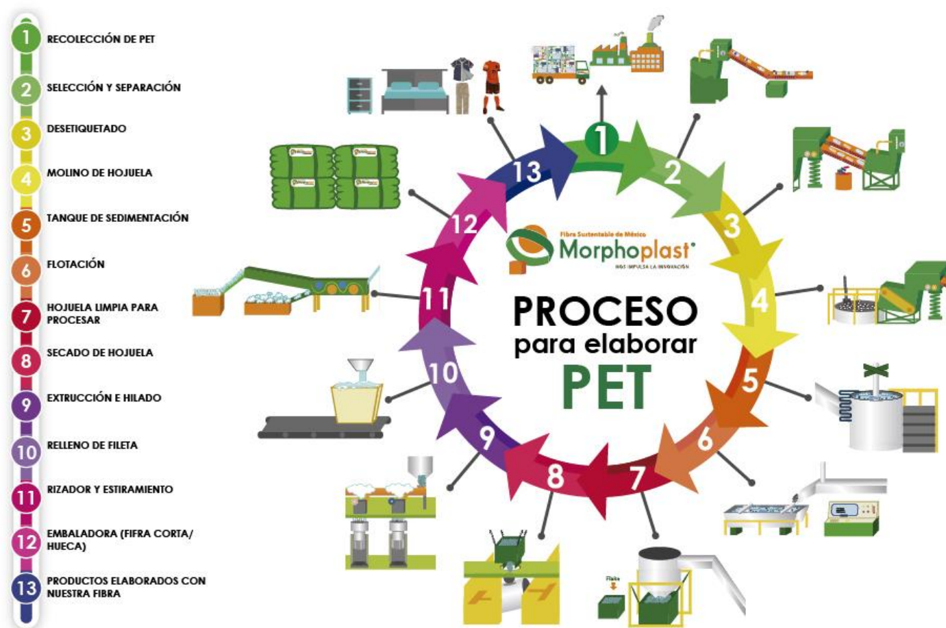
Ilustración: Proceso para la elaboración del PET
