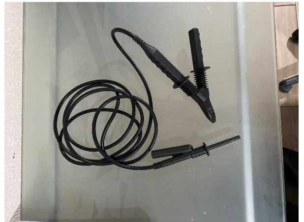
Un cable de alta tensión de seguridad apantallado negro, de 3 m de longitud, dotado de un conector de alta tensión con toma trasera en un lado y una pinza cocodrilo en el otro.
