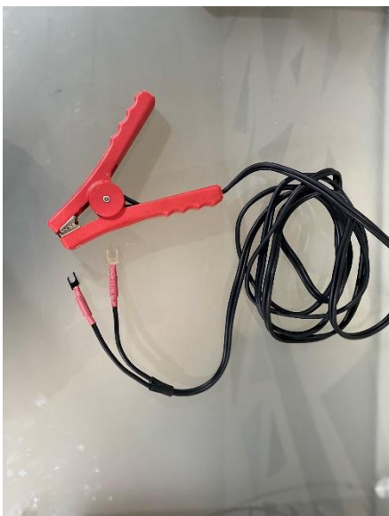
Caimanes de conexión positivo y negativos, entrada tipo kelvin
