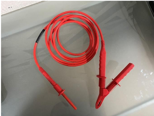
2 cables de alta tensión de seguridad, uno rojo y uno azul, de 3 m de longitud, dotados de un conector de alta tensión en un lado y una pinza cocodrilo en el otro.
