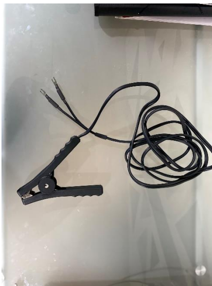
Caimanes de conexión positivo y negativos, entrada tipo kelvin
