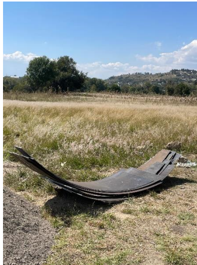
Imagen 65 Gajos del tanque
