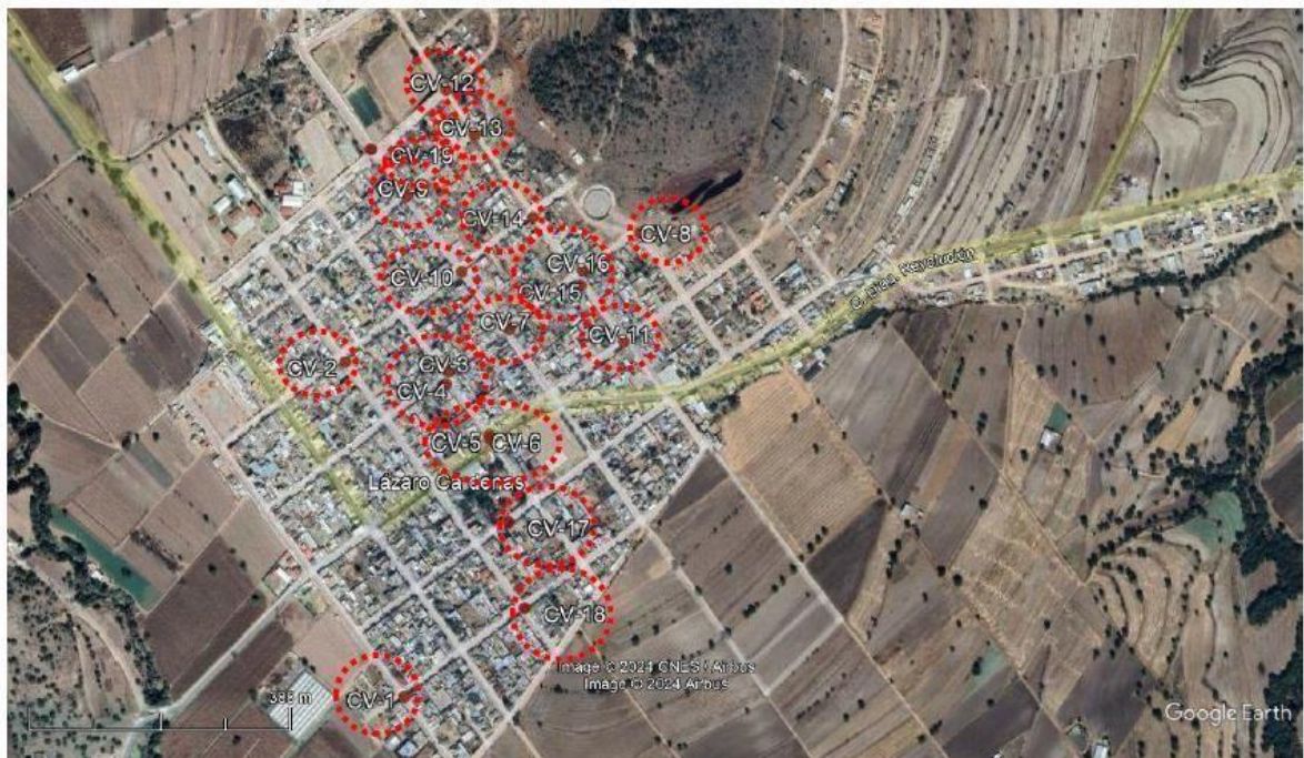
Imagen 23. Ubicación de cajas de válvulas
