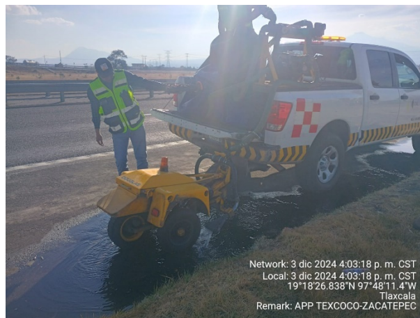
Imagen 16. Evaluación de coeficiente de fricción de pavimento con equipo Mu Meter. Fuente: Propia
