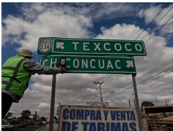
Imagen 22. Medición del coeficiente de retroflexión. Fuente: Propia
