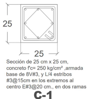
Ilustración 32. Columna C-1, fuente: propia.
