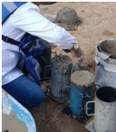
Fotografía 32. Recolección de muestras de concreto para prueba de resistencia de concreto, fuente: propia.
