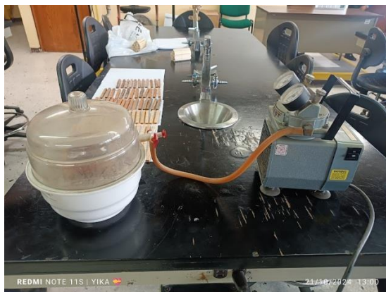
Figura 6. Impregnación de las probetas con nanopartículas de óxido de ZnO.
