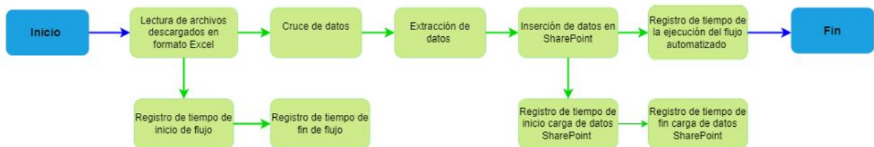
Diagrama 2. Estructura del Proceso de Automatización de desarrollo de ETL para encuestas de servicio con Power Automate
