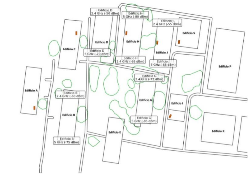
Figura 13 Mapa de cobertura estimada y ubicación propuesta de puntos de acceso inalámbrico.
