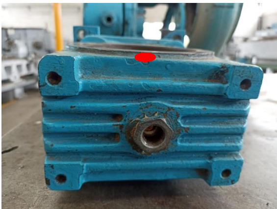
Figura 45 Vista lateral del posicionamiento del sensor en lectura axial
