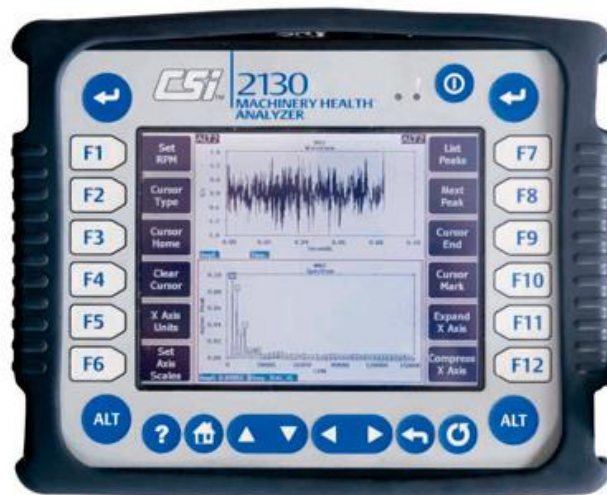
Figura 24 Analizador de vibraciones CSI 2130
