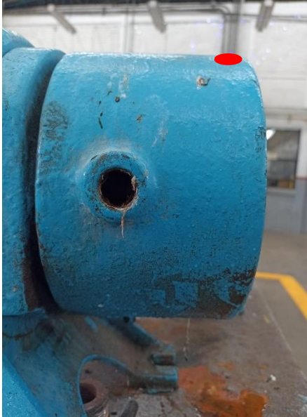
Figura 39 Vista lateral de posicionamiento del sensor en lectura vertical
