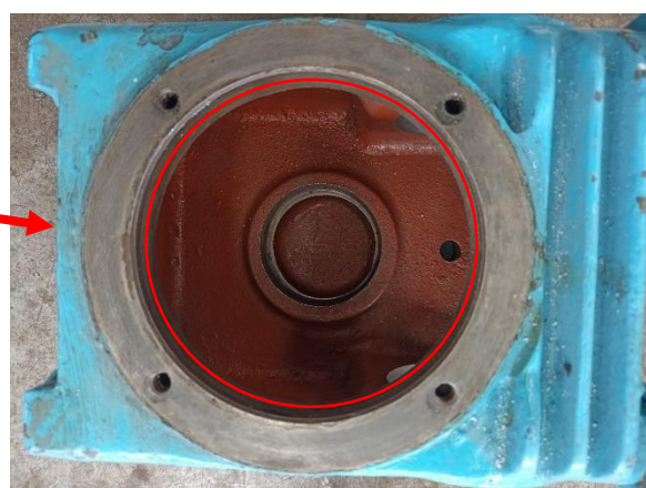
Figura 44 Vista frontal del posicionamiento del sensor en lectura axial
