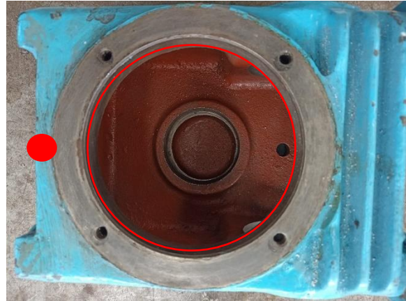
Figura 43 Vista frontal del posicionamiento del sensor en lectura radial
