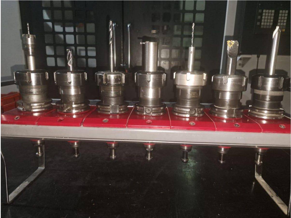
Figura 3: Fotografía tomada por la autora (2025) en el taller de producción de FUNHEDI S.A. de C.V., donde se aprecian fresas, brocas y herramientas de inserto empleadas en operaciones de maquinado CNC.
