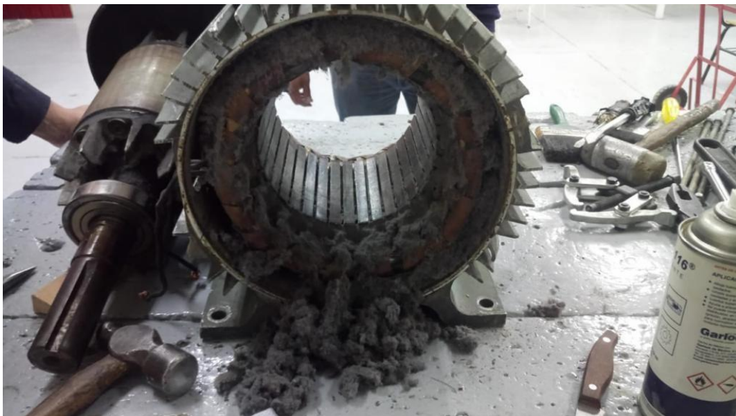
Imagen 8: Motor con necesidad de mantenimiento
