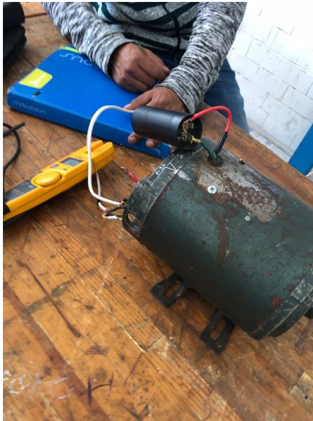
Imagen 7: Colocación del capacitor de arranque al motor C.A
