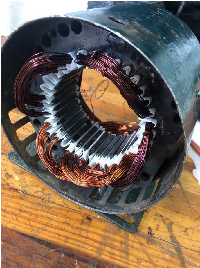
Imagen 16: Colocación de las bobinas en el estator.
