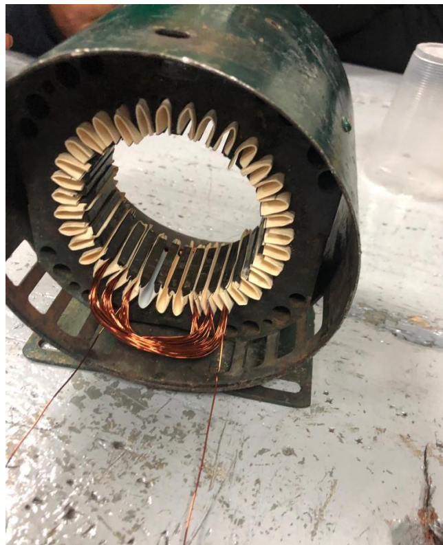
Imagen 13: Colocación de aislantes de ranuras
