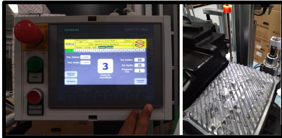
Figura 3.185 Registrando tercer punto de atornillado
