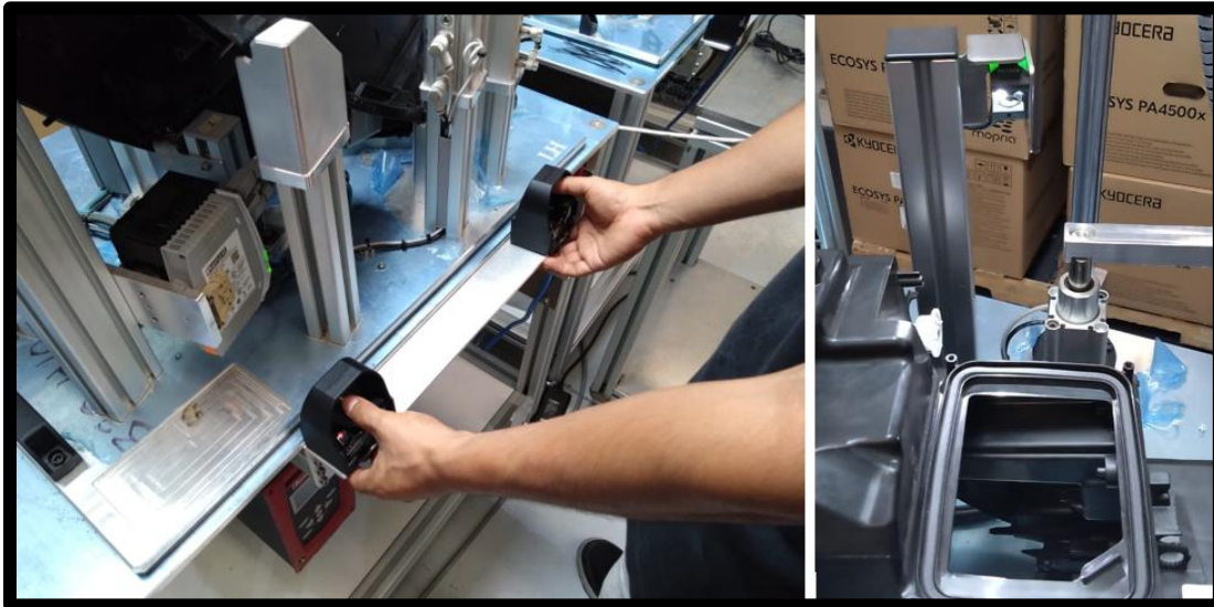
Figura 4.8 Presionando bimanuales para realizar inspección visual
