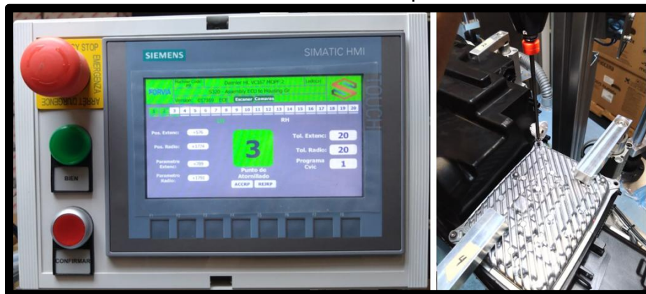
Figura 4.13 Realizando tercer punto de atornillado
