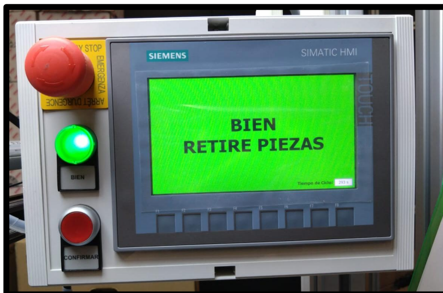
Figura 4.17 Mensaje de pieza correctamente ensamblada en HMI
