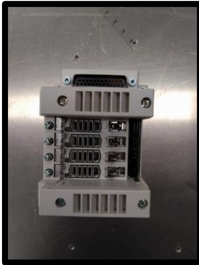
Figura 3.50 Bloc de válvulas
