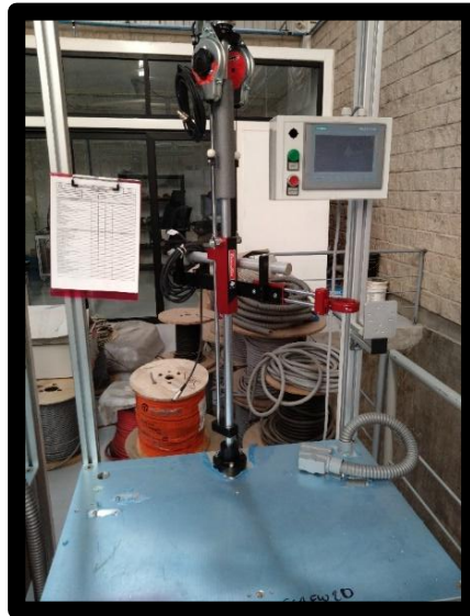
Figura 3.97 Instalando pedestales de atornillador en estaciones
