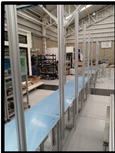
Figura 3.70 Ensamblando estructura central de estaciones
