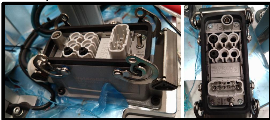
Figura 3.141 Atornillando conector harting derecho
