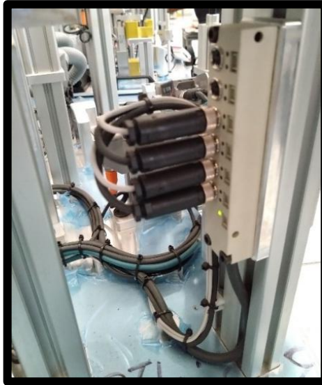
Figura 3.136 Conectando sensores en distribuidor de sensores
