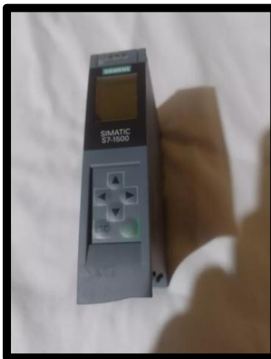
Figura 3.31 PLC Siemens S7-1500
