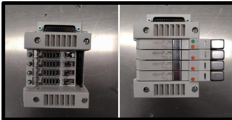
Figura 3.84 Insertando electroválvulas en bloc de válvulas
