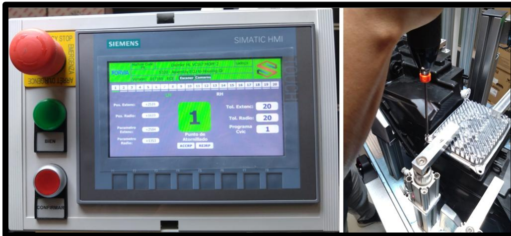
Figura 4.11 Realizando primer punto de atornillado
