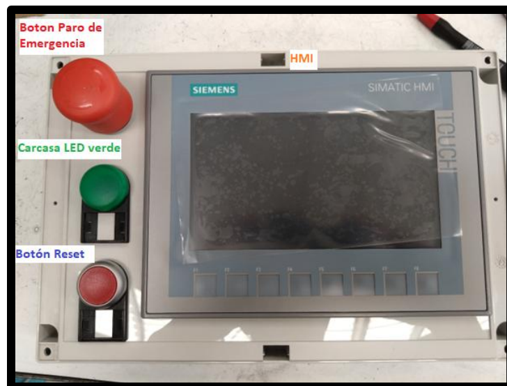
Figura 3.88 Instalando elementos externos de botonera
