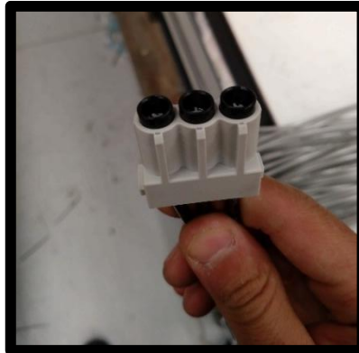
Figura 3.80 Pines de manguera insertados en carcasas eléctricas
