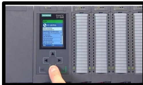
Figura 2.8 PLC Siemens S7-1500
