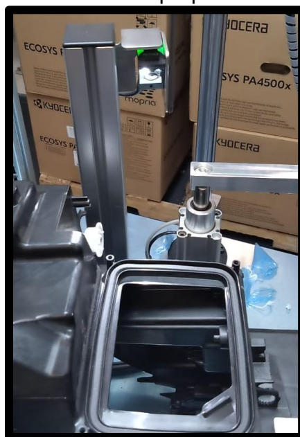
Figura 3.197 Ajustando mecánicamente el sistema de visión
