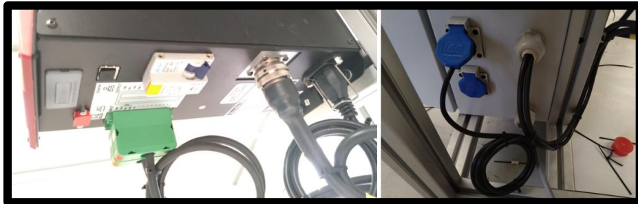
Figura 3.100 Cableado elementos de controlador de atornillador CVIC
