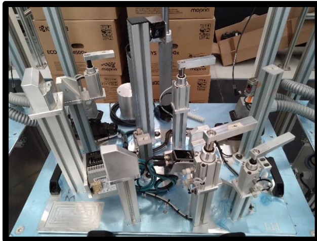
Figura 3.134 Insertando elementos neumáticos y eléctricos de estación
