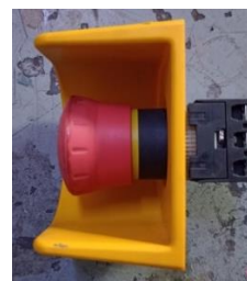
Ilustración 194. Ensamble de botón de paro de emergencia
