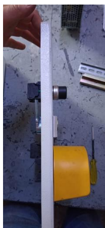
Ilustración 200. Ensamble de botones en puerta de tablero eléctrico
