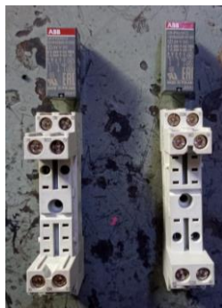
Ilustración 184. Base de relevador y relevador ABB
