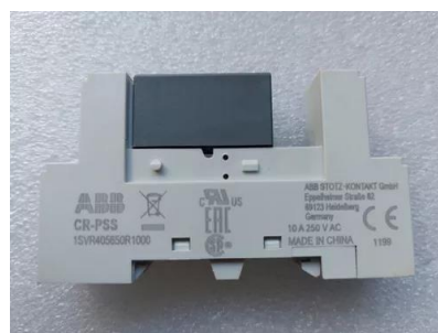
Ilustración 93. Base de relevador con relevador colocado
