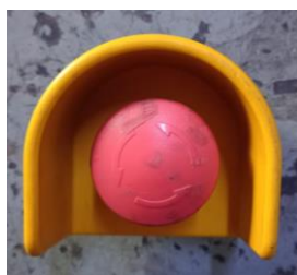
Ilustración 194. Ensamble de botón de paro de emergencia
