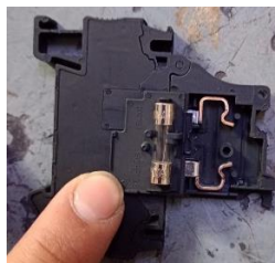
Ilustración 199. Ensamble de fusible y clema porta fusibles
