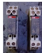
Ilustración 198. Ensamble de base y relevador
