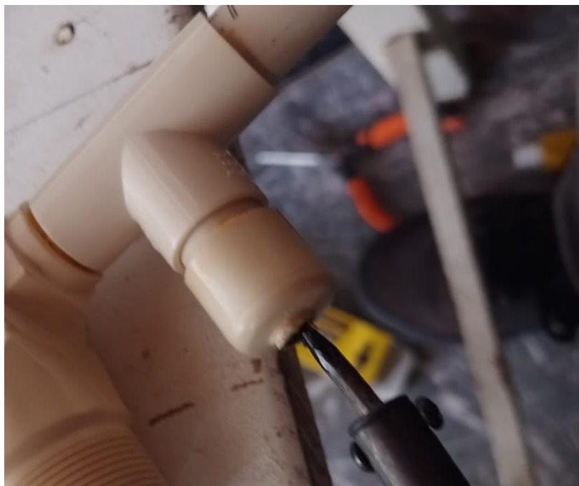
Figura 153 Orificio en el tapón donde ira el sensor DS18B20.
