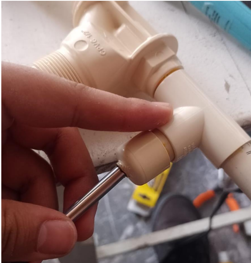
Figura 154 Ingreso del sensor DS18B20 en el orificio
