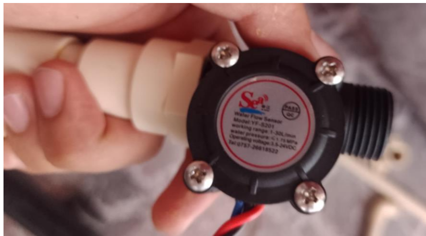
Figura 151 Conexión de caudalímetro con tubos y conexiones necesarias.
