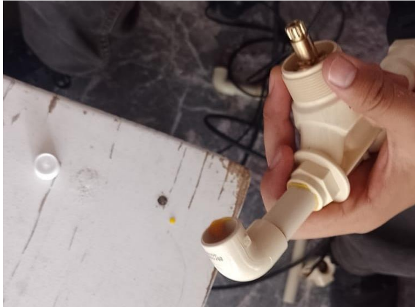
Figura 150 válvula de paso con conexiones de tubo y codo.
