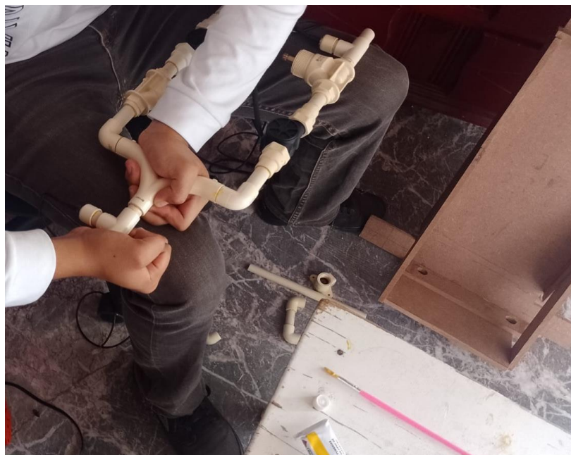
Figura 164 Se adhiere la te de CCPVC que conecta al bigote con el sensor.
