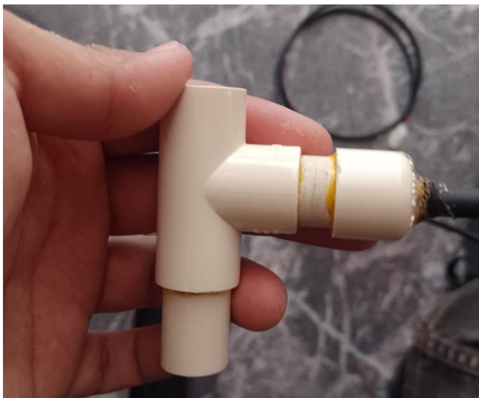
Figura 156 Sensor DS18B20 aislado correctamente.
