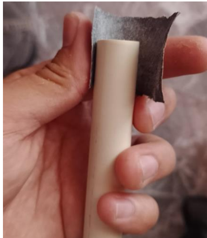
Figura 147 Pieza sutilmente lijada de la parte externa.
