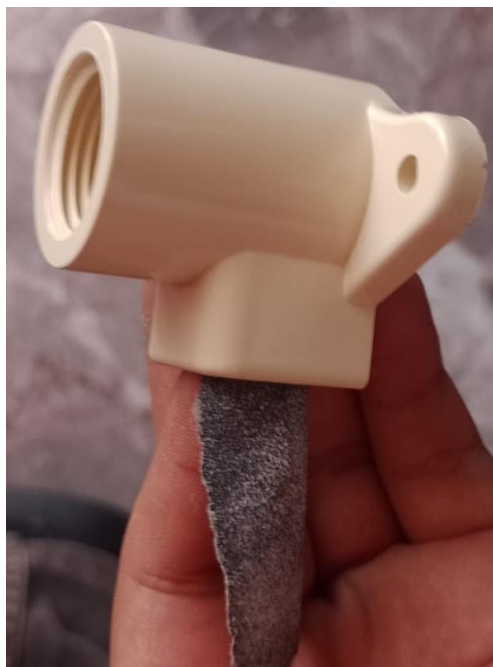
Figura 146 Pieza sutilmente lijada de la parte interna.
