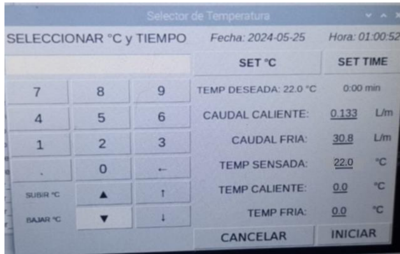
Figura 208 Temporizador en cero y temperatura deseada igual a la sensada.
