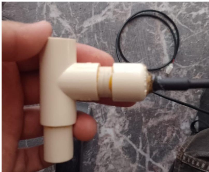
Figura 159 Sensor de temperatura en su pieza de tubería.
