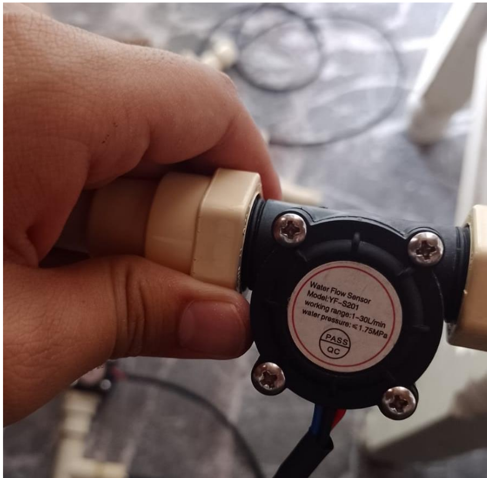
Figura 157 caudalímetro adherido correctamente.
