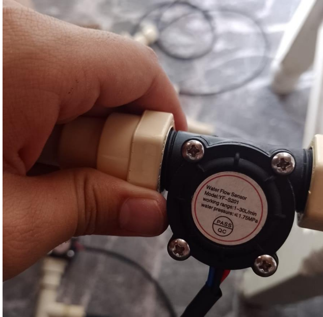
Figura 152 Conexión de ambos lados del caudalímetro.
