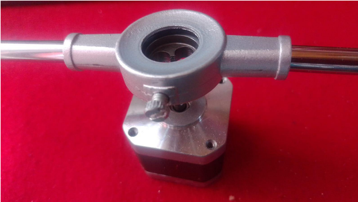
Figura 169 Tarraja colocada para girar.
