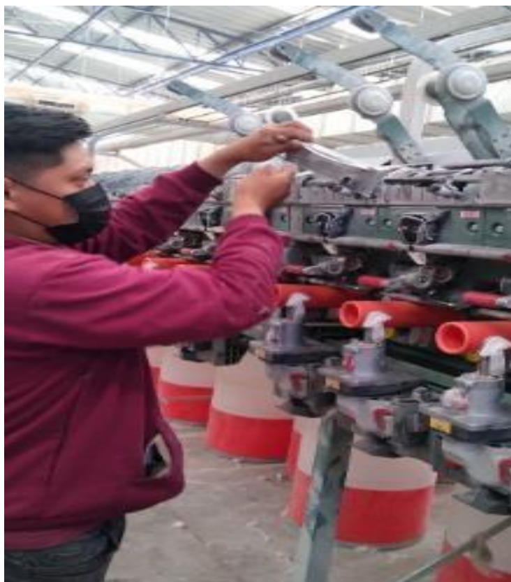
Ilustración 4.14. Limpieza e Inspección de los soportes y los silos de las bobinas de alimentación del área de Open-end.
