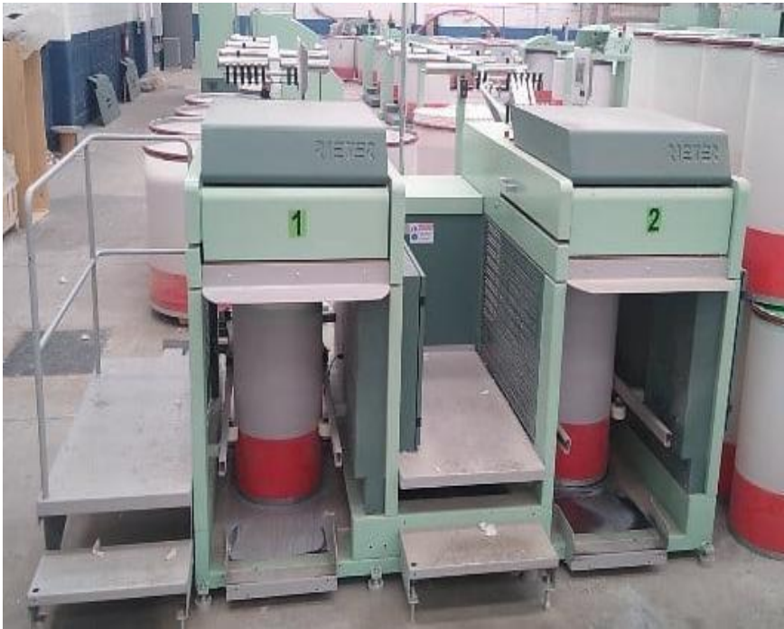
Ilustración 2.10. RSB-D26 Autorregulador De Dos Entregas
