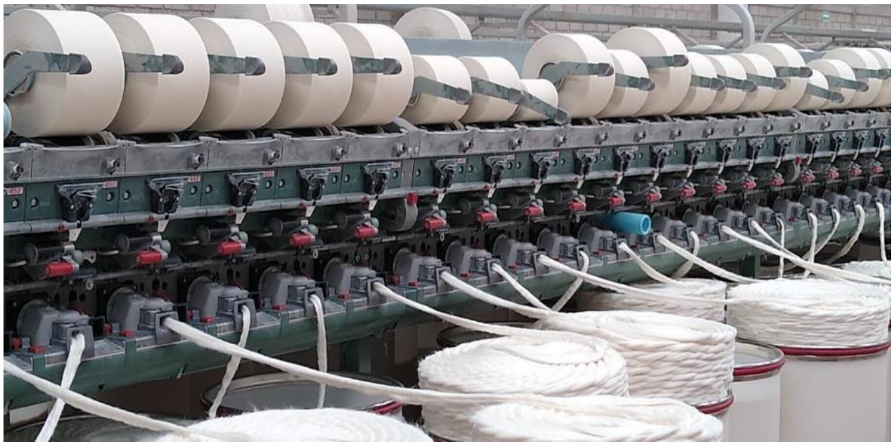
Ilustración 1.10. Las fibras se entrelazan y se mantienen unidas, creando el hilo a rotor.
