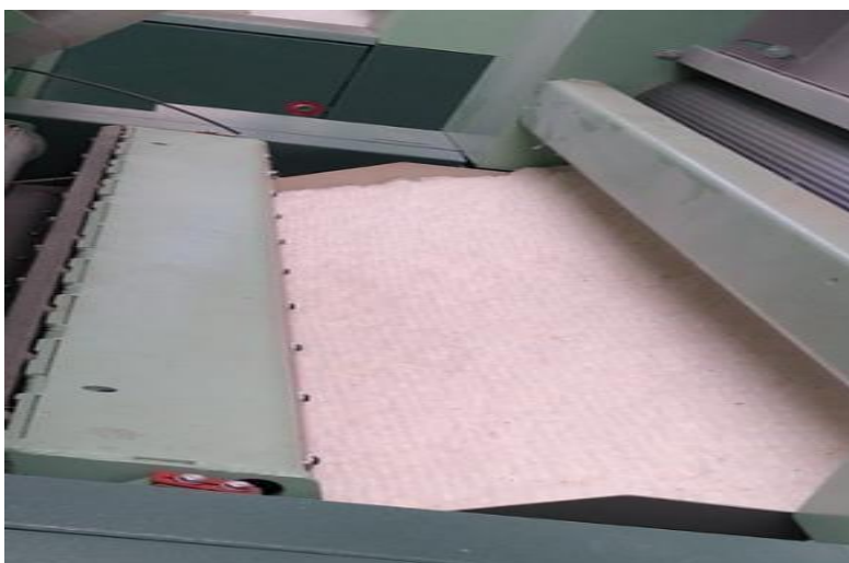
Ilustración 1.7. El algodón se somete al proceso de cardado.
