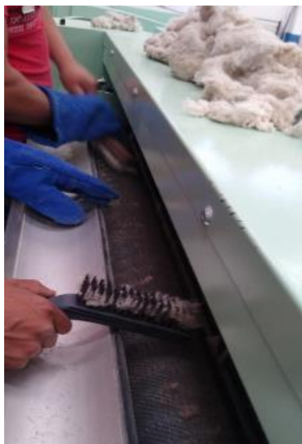
Ilustración 4.11. Limpieza del cilindro de limpieza de carda
