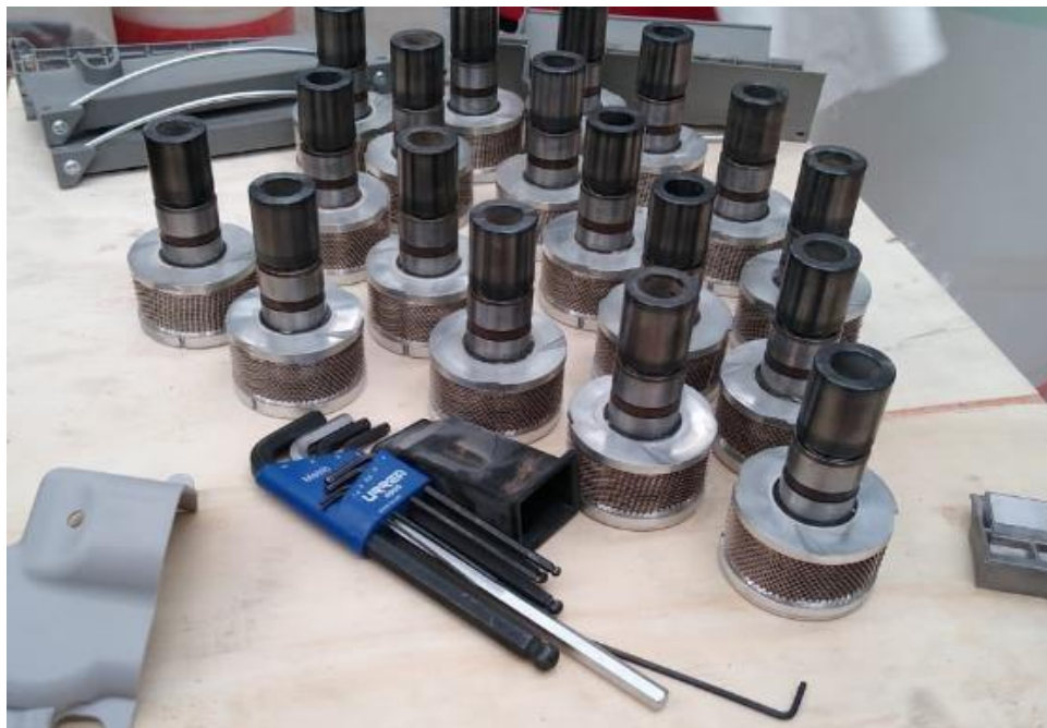
Ilustración 4.13. Limpieza e inspección del cilindro disgregador de la OpenEnd.
