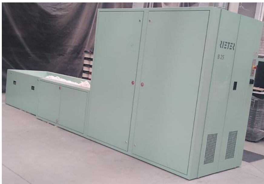
Ilustración 2.3. B25 Abridora de Balas.
