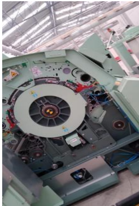
Ilustración 4.12. Limpieza e inspección del Doffer. Cardas
