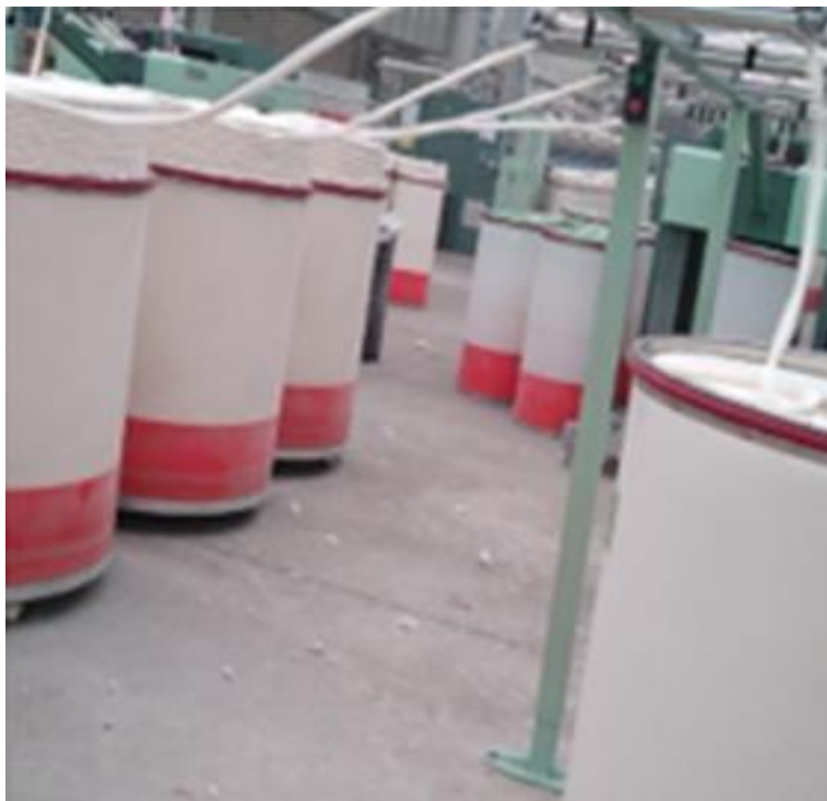
Ilustración 1.9. Combinación de hebras para crear hilo más grueso.
