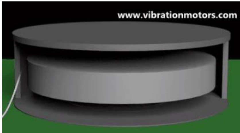
Figure 23 Movimiento lineal en el eje Z de un actuador lineal resonante (Vibration motors, 2020).
