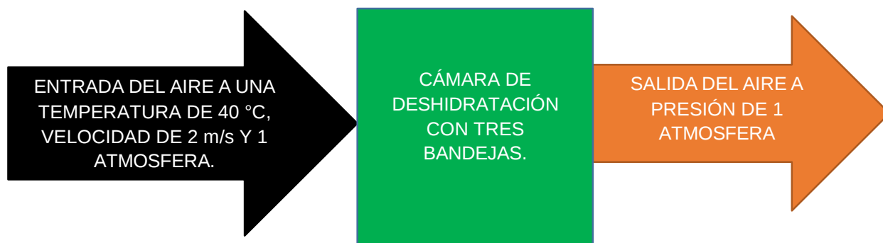
Fig. 4.5. Condiciones de entrada y salida del aire
