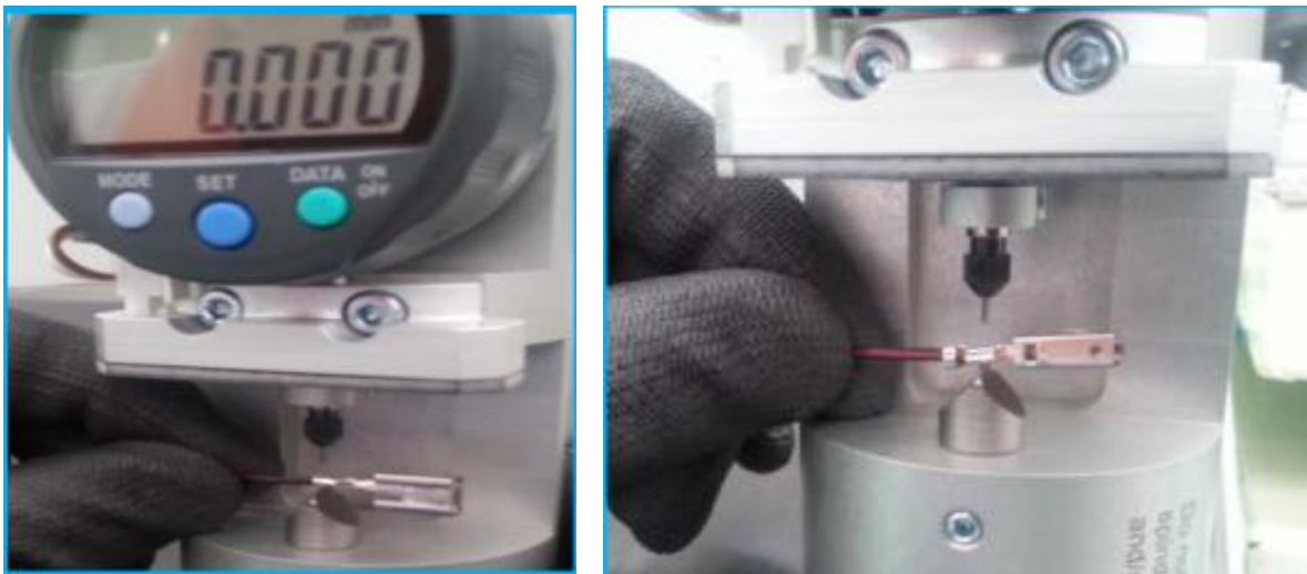
Imagen 22. Posición correcta para la medición de la altura de la terminal
