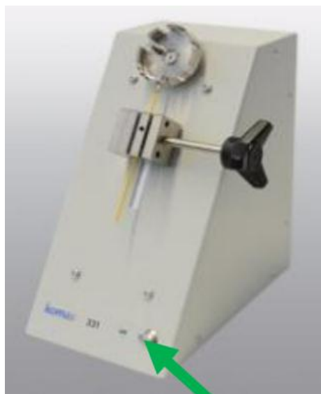
Imagen 26. Forma correcta para medir la fuerza de extracción
