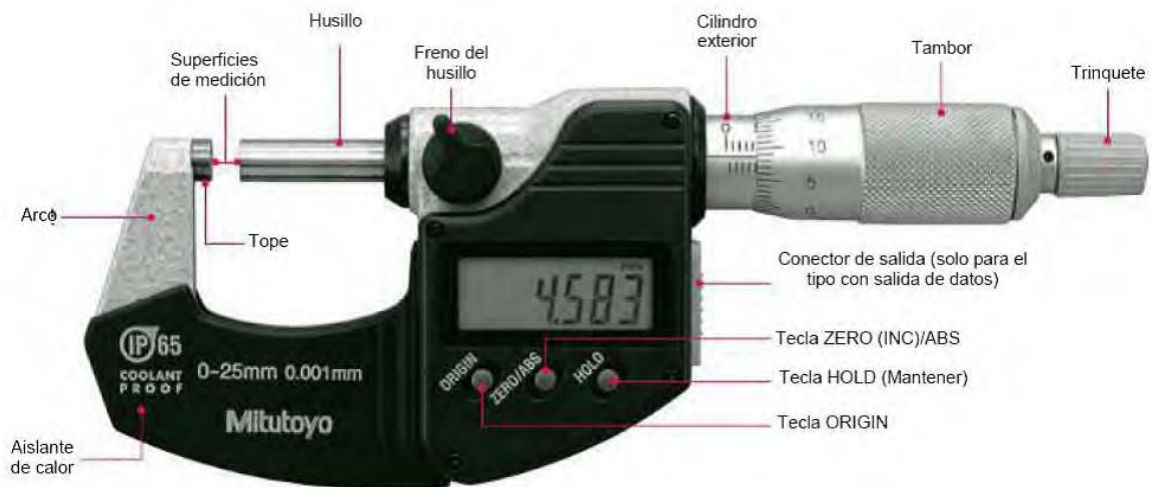
Imagen 18. Partes del micrómetro
