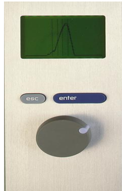
Imagen 8. Analizador de fuerza de crimpado CFA
