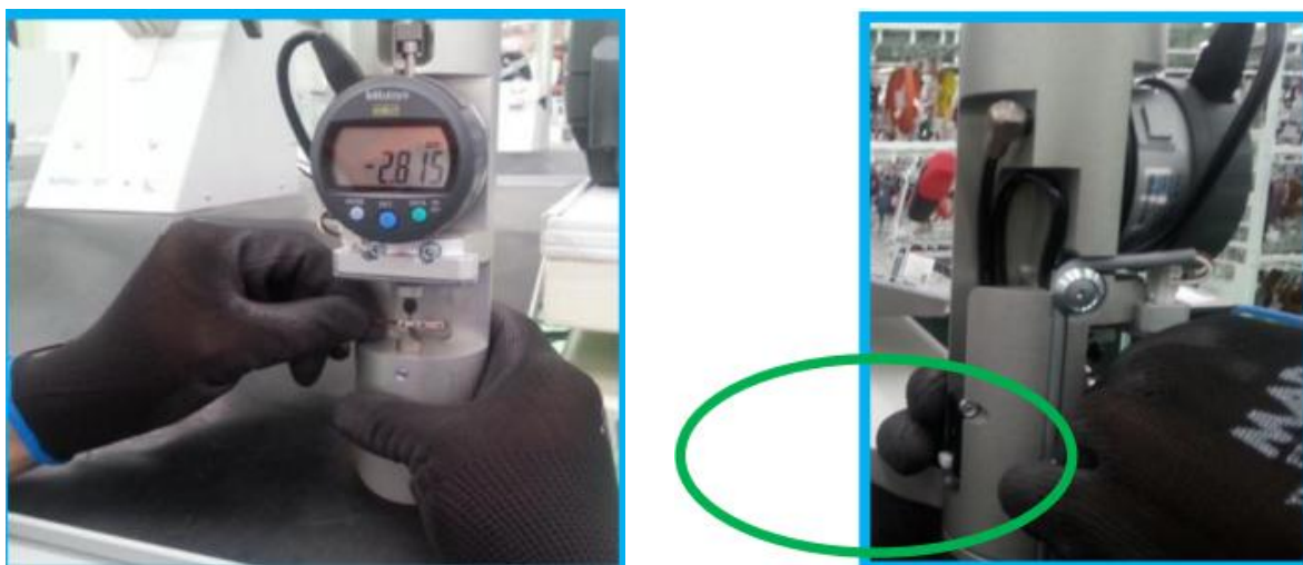
Imagen 23. Medición obtenida del cable engastado
