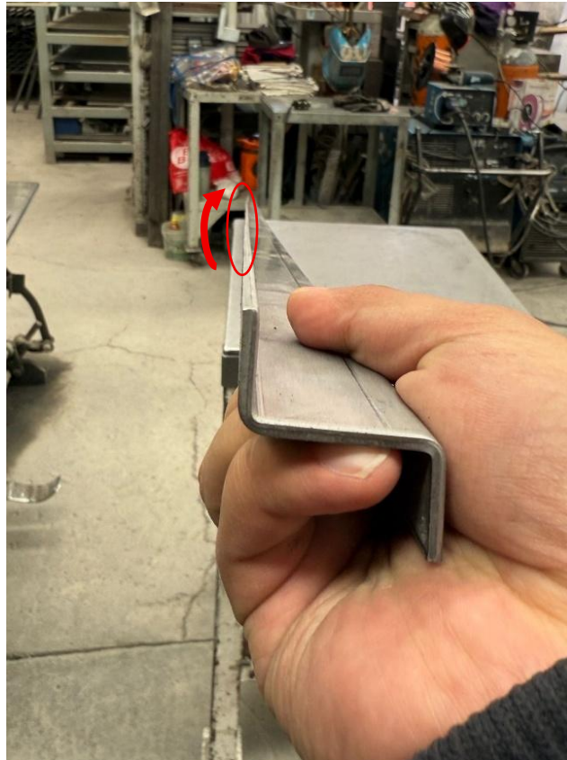
Ilustración 18. Falta de doblez en pieza de calibración
