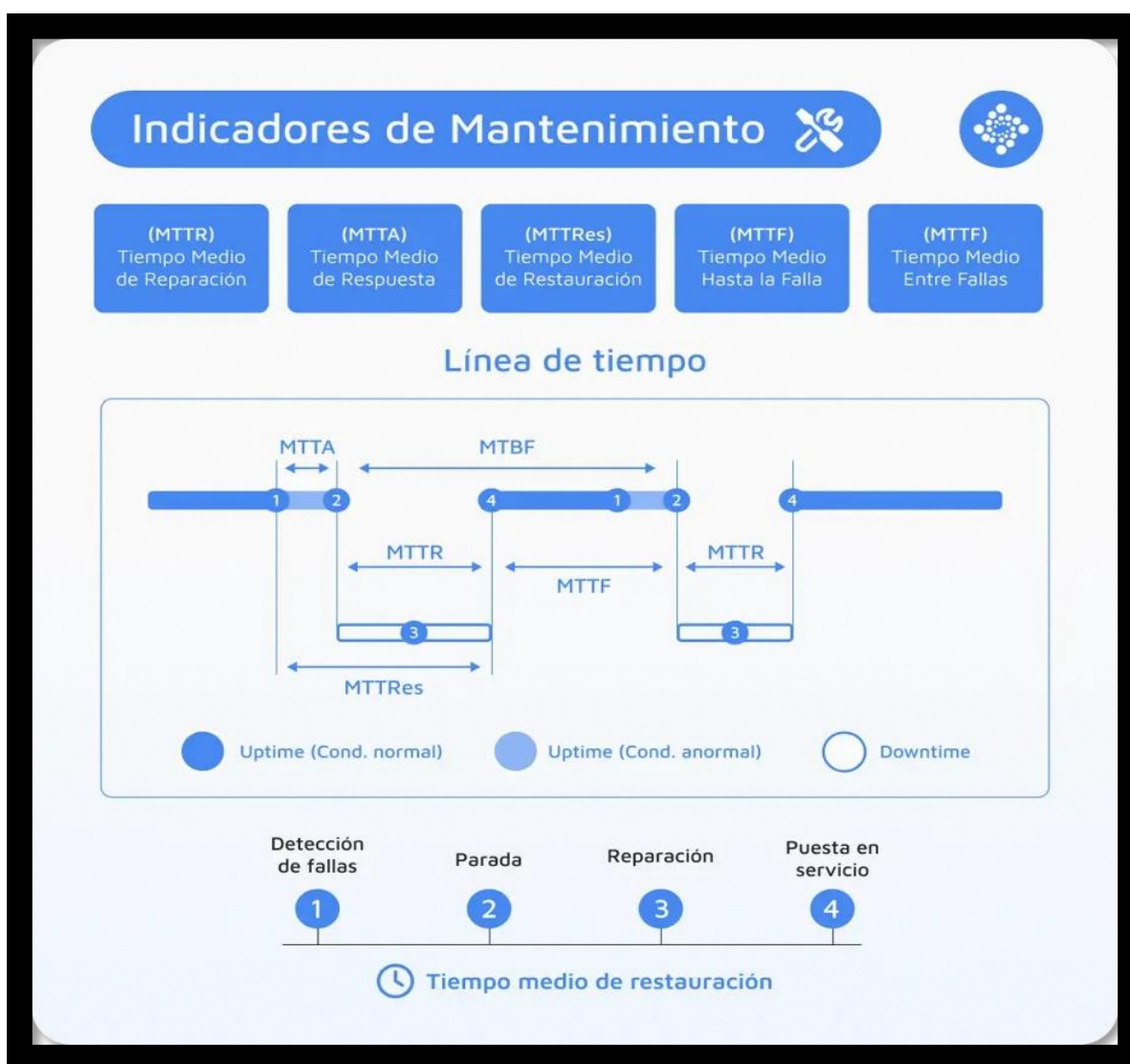
Ilustración 38. Componentes del tiempo de reparación (MTTR) en el mantenimiento correctivo. Fractal
