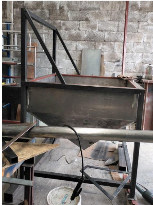
Fig.- 19 Diseño estructural de la tolva en físico.
