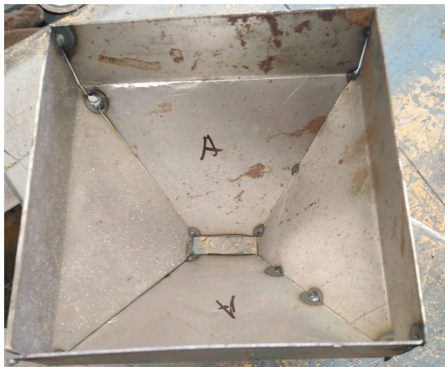
Fig.- 13 Chapa metálica de la tolva en físico.
