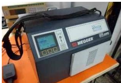
Figura 3.10 Equipo de prueba de rigidez dieléctrica
