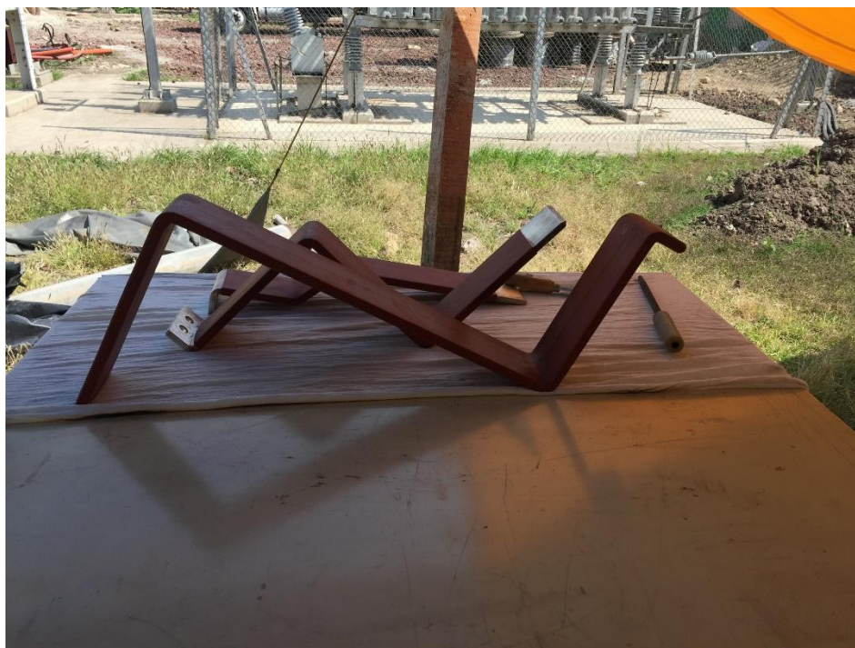
Figura 6.29 Barras con manga termo contráctil de 35 Kv's
