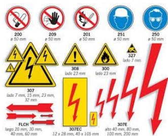
Figura 1.9 Señalamientos de peligro
