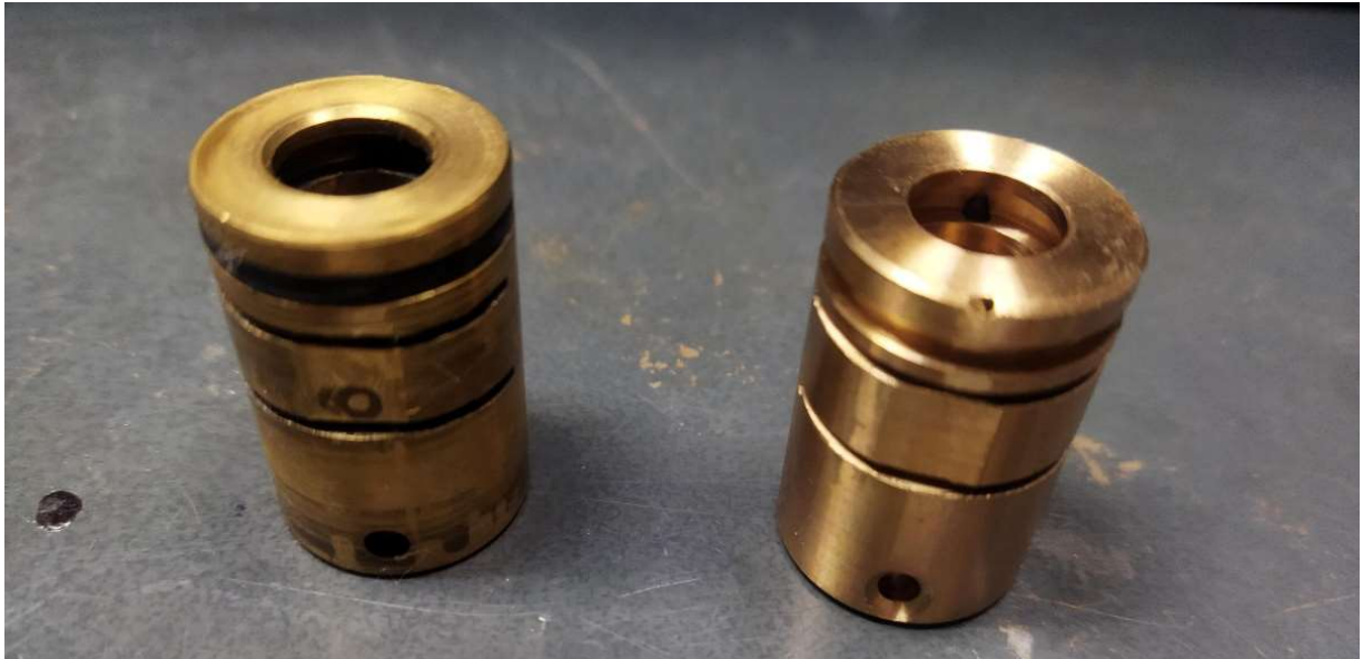
Figura 4.24 Buje de cabezal con desgaste - nuevo
