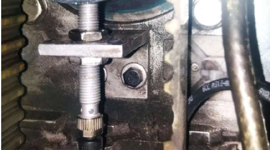
Figura 4.46 Cambio de sensor de tornillo
