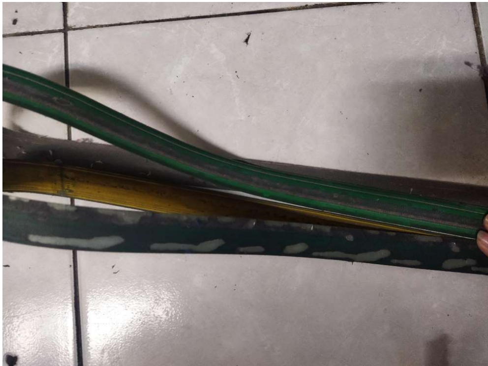
Figura 4.19 Banda sin fin con desgaste
