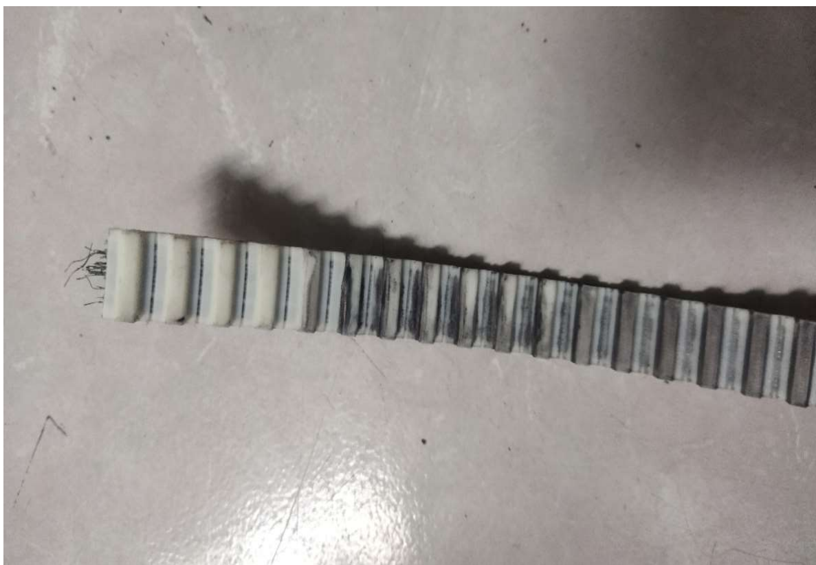
Figura 4.21 Banda dentada rota por desgaste
