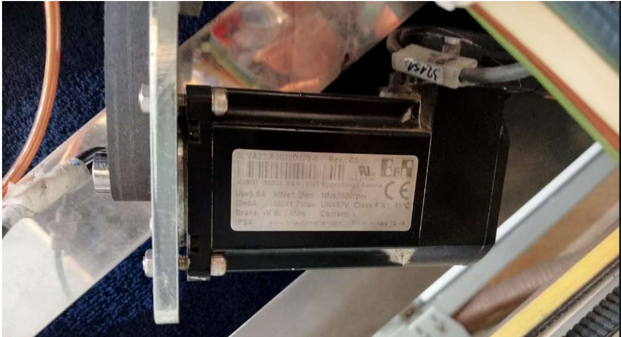
Figura 4.52 Cambio de servomotor 2
