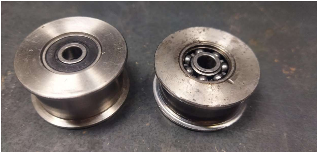
Figura 4.31 Polea chica nueva - con desgaste
