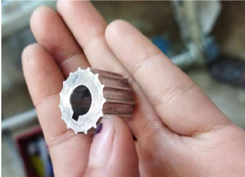
Figura 4.32 Polea dentada con desgaste
