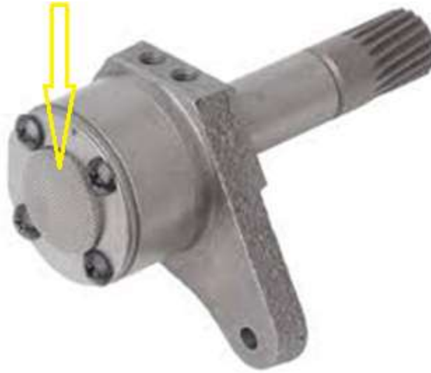
Figura 4.38 Bomba de aceite - principal desgaste
