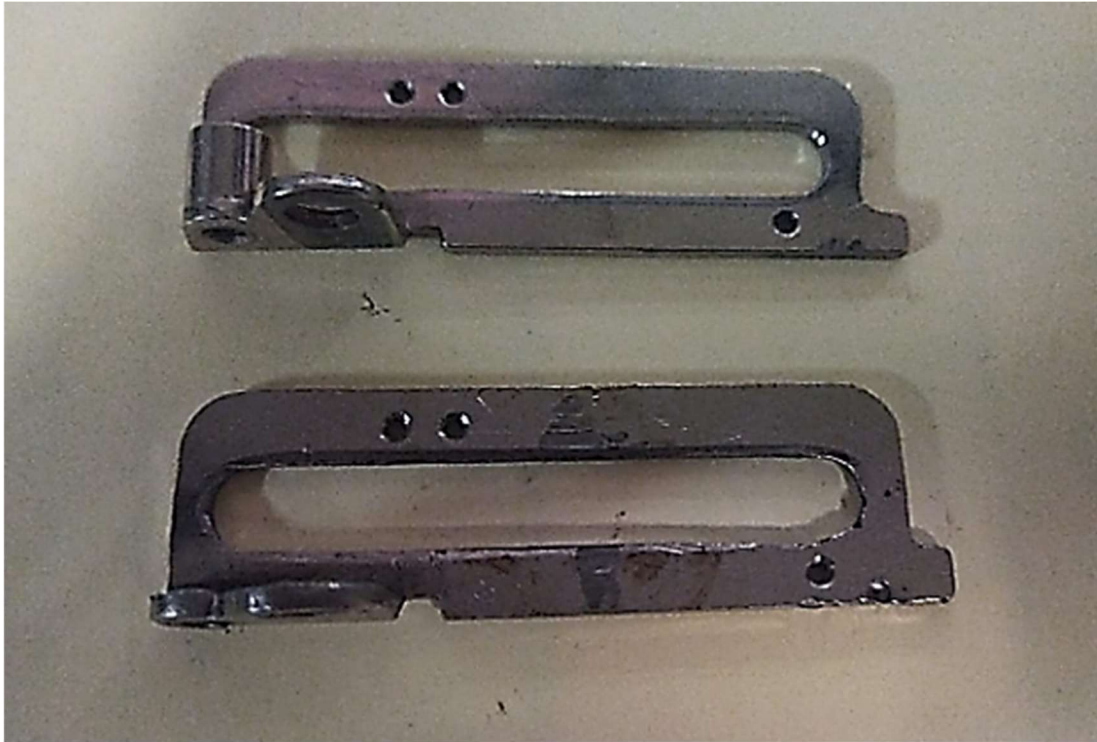
Figura 4.26 Guía hilo con desgaste
