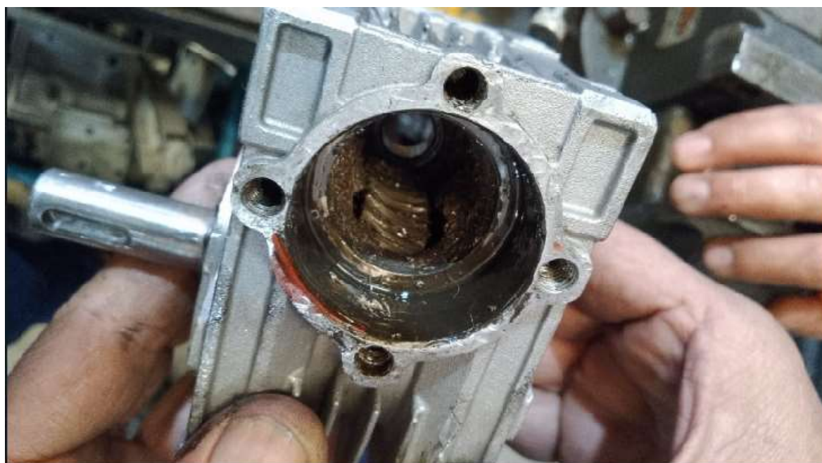
Figura 4.57 Daño en corona de bronce del reductor
