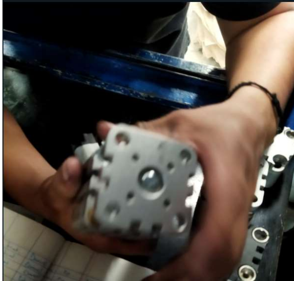
Figura 4.54 Cambio de pistón
