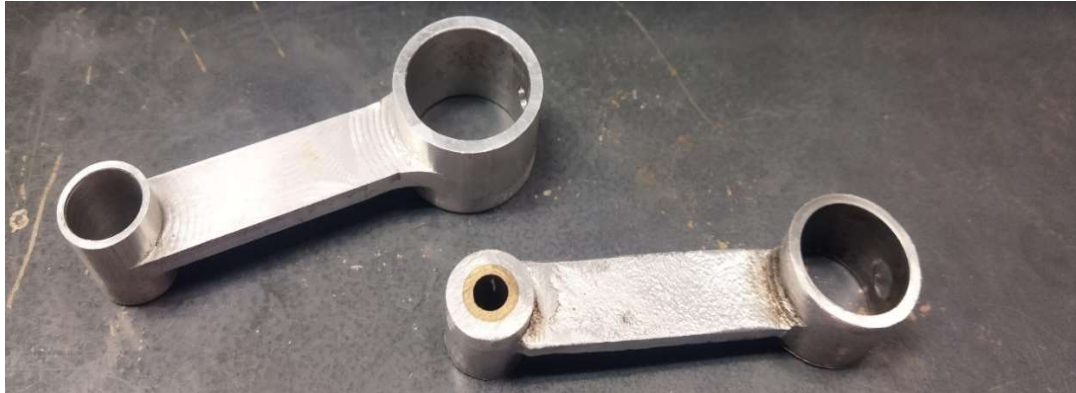
Figura 4.28 Bielas fabricadas t-1 nueva y con desgaste
