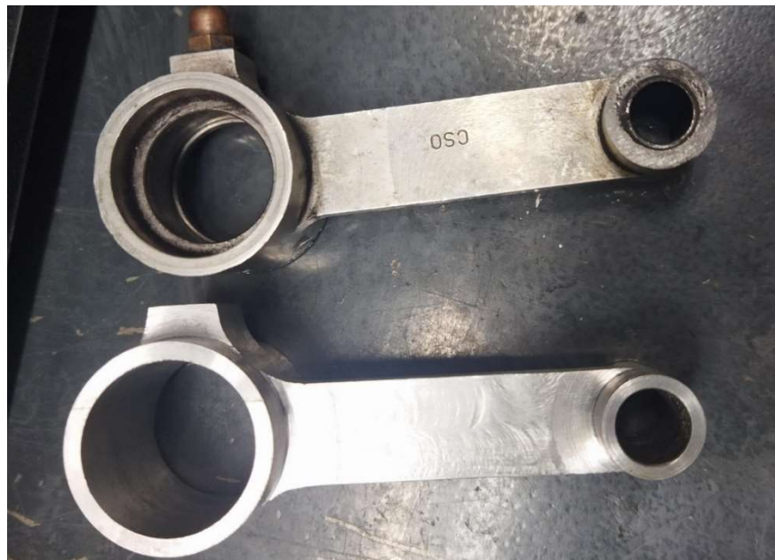
Figura 4.29 Biela para refiladora t-2 desgastada – nueva
