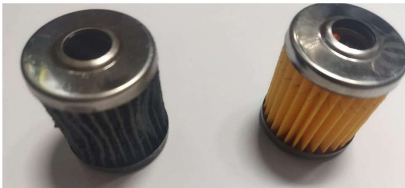
Figura 4.35 Filtro de aceite contaminado – nuevo
