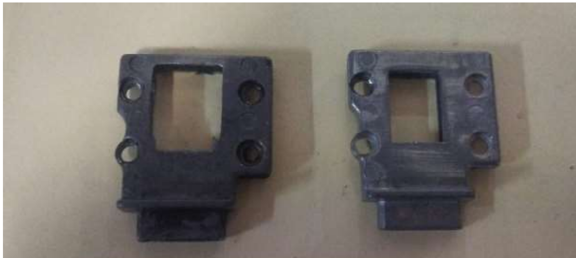
Figura 4.37 Sello de aceite de barra de alimentación uso- nueva
