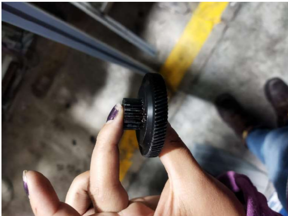
Figura 4.33 Engrane con desgaste
