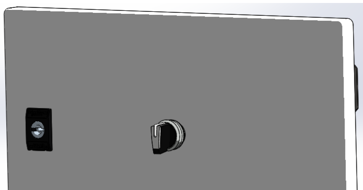
Fig. 37. Selector para los modos de funcionamiento (fuente: elaboración propia).
