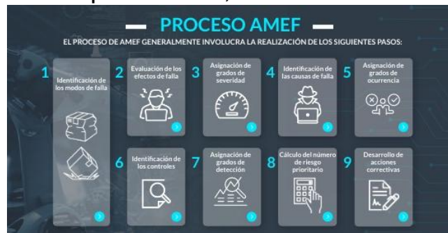
Ilustración 6 Procedimiento para realizar el AMEF de un proceso. (s.f.). Análisis Modal de Efectos y Fallas (AMEF).
