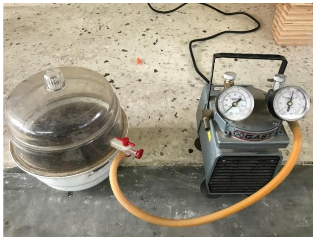
Figura 5. Proceso vacío aplicado a las muestras.
