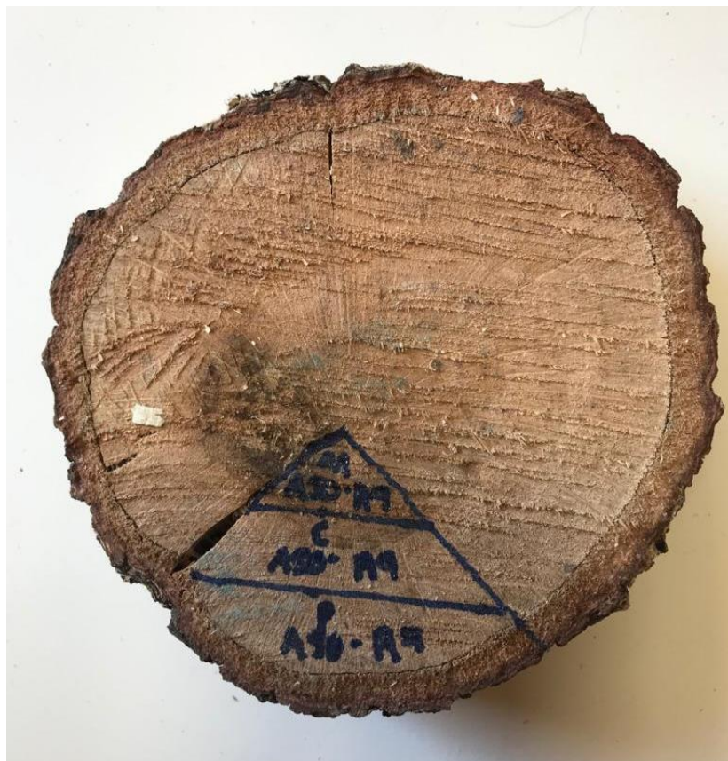
Figura 3. Obtención de las muestras de la médula, centro y periferia en la rodaja.
