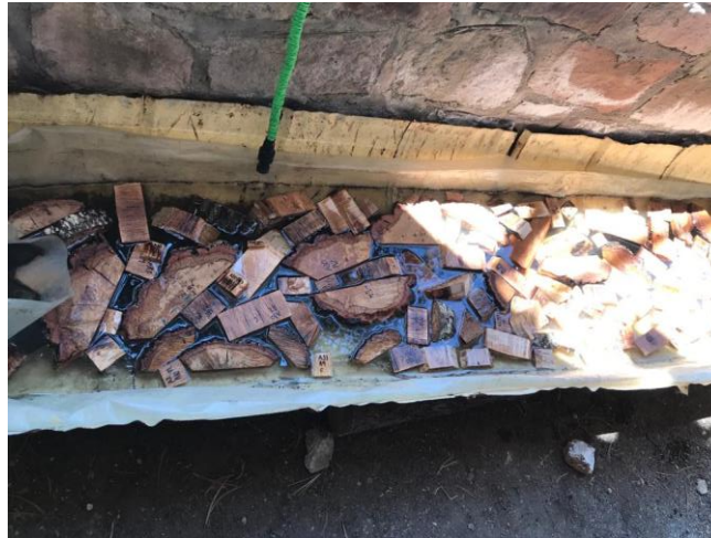
Figura 4. Saturación de las muestras en agua hasta peso constante.
