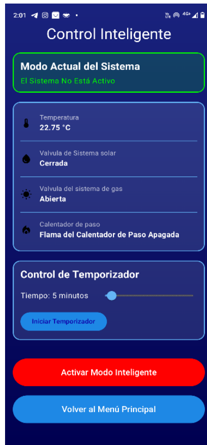
Figura 43: Cambio automático de válvulas en el control Inteligente
