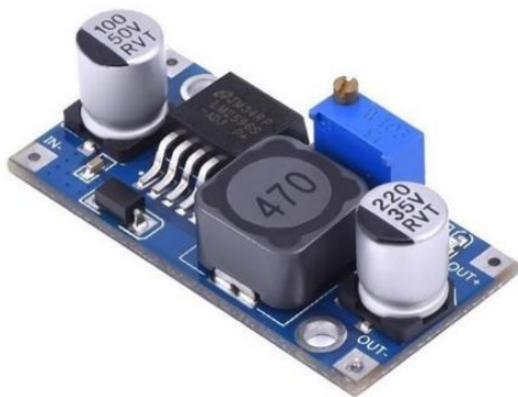
Figura 17: Regulador de voltaje
