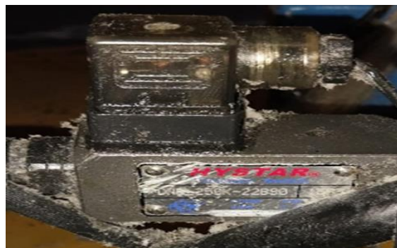
Figura 10. sensor de seguridad Hystar DN-250K-22B90 con rango de presión ajustable
