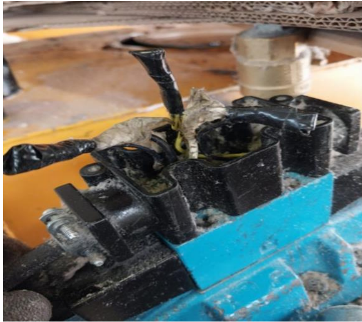
Figura 8. fotografía de electroválvula BTA 2109, perteneciente a planta Blue Tissue
