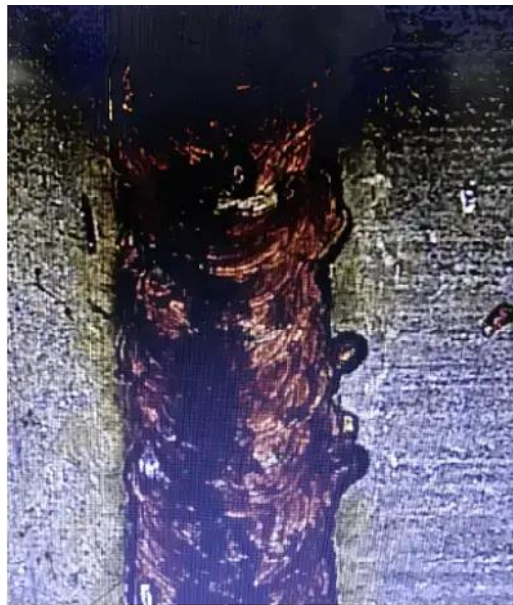
Ilustración 9: Salpicaduras en soldadura. Extraído de: (Shane, Machine MFG, 2023)
