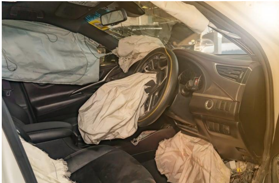
Ilustración 11: Airbags en un choque real. Extraído de: (Loctite Teroson, 2021)
