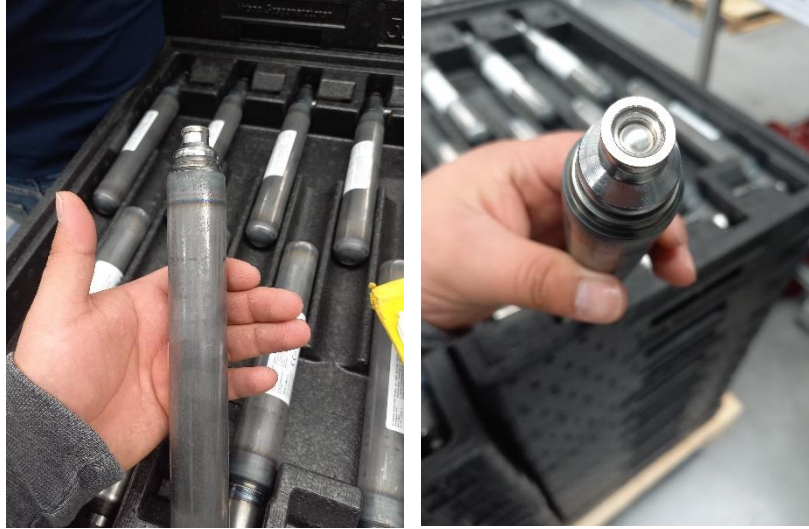
Ilustración 20: Tanque antes de ser ensamblado con el activador. Imagen derecha se observa el tanque completo y en la imagen de la izquierda se observa la membrana.
