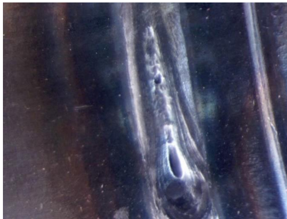
Ilustración 32: Socavón en soldadura laser en uno de los infladores de muestra. Fotografía tomada por el autor
