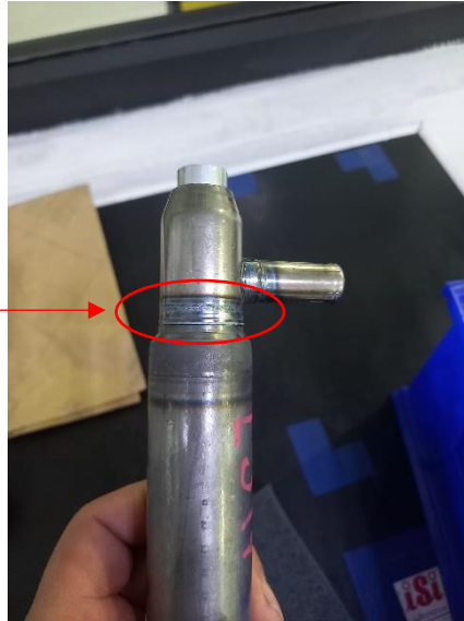
Ilustración 21: Zona de soldadura. Fotografía tomada por autor.
