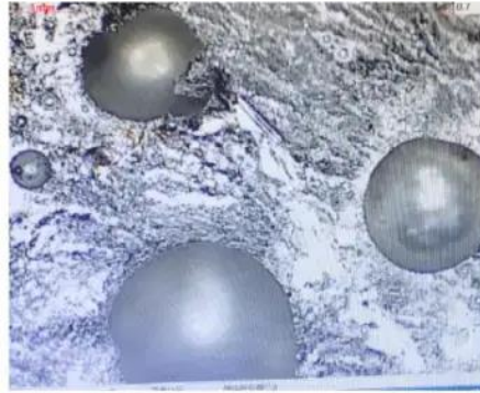
Ilustración 7: Porosidad en soldadura. Extraído de: (Shane, Machine MFG, 2023)
