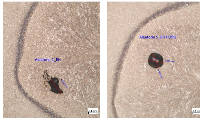
Ilustración 36: Probetas 4 y 5; muestras con poros. Fotografías tomadas por el autor.
