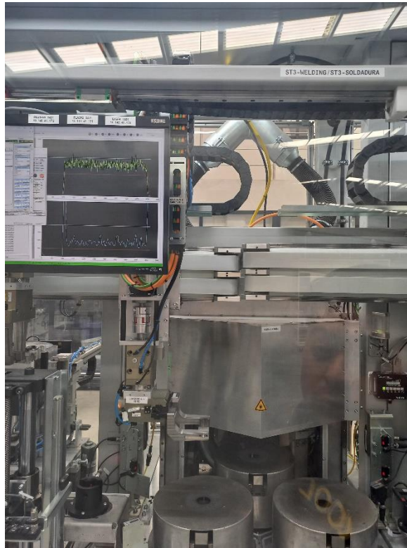
Ilustración 19: Monitoreo de los límites superior e inferior de la soldadura. Fotografía tomada por el autor.
