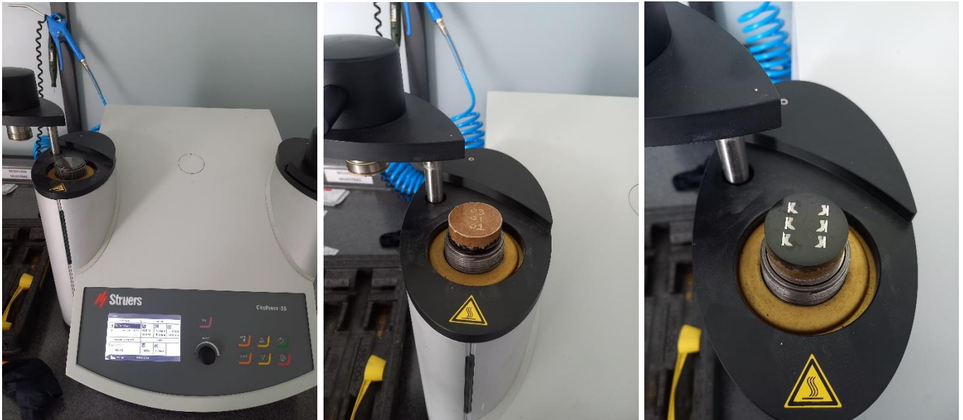
Ilustración 24: Proceso para realizar la probeta. En la imagen de la izquierda se observa la maquina (CitoPress-30) con las instrucciones de trabajo, en la imagen de en medio se observa la probeta terminada, en la imagen de la derecha se observa la parte inferior de la probeta mostrando las muestras. Fotografías tomadas por el autor
