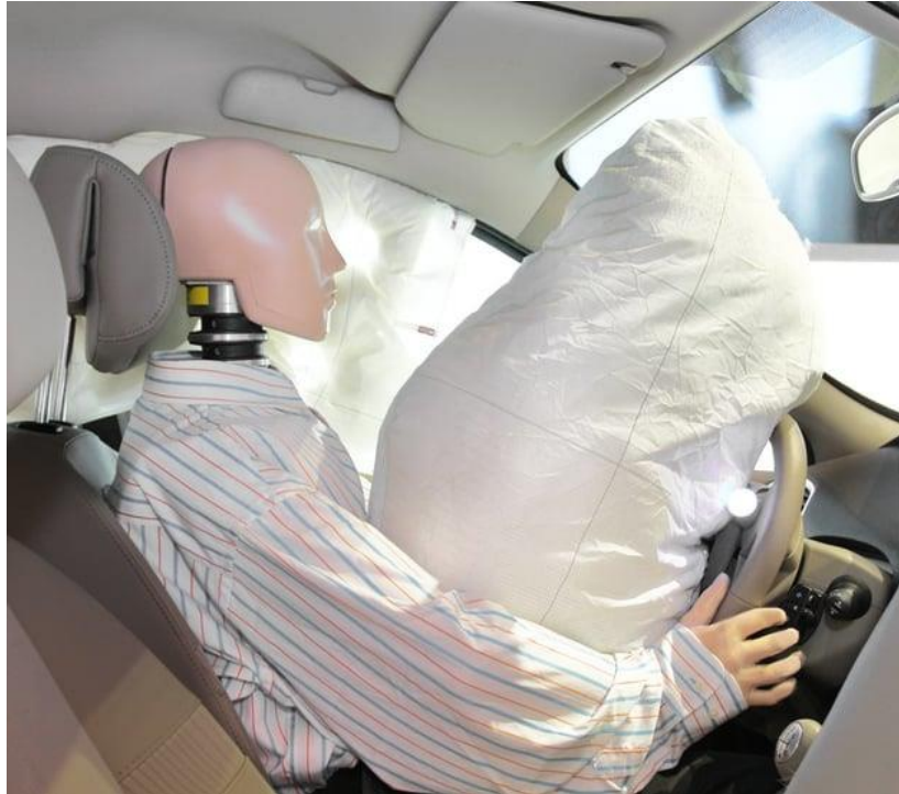
Ilustración 10: Airbags en una simulación de choque. Extraído de: (Loctite Teroson, 2021)
