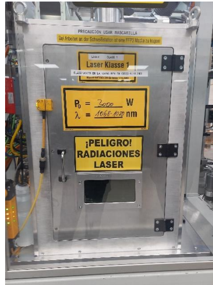
Ilustración 18: Especificaciones del láser. Fotografía tomada por el autor.
