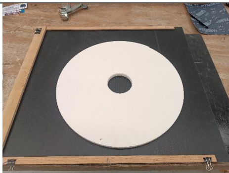
Ilustración 21 Tablero, guías exteriores y cinta doble cara
