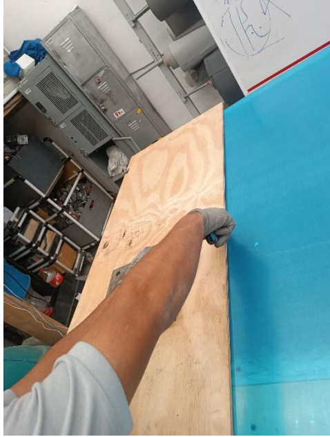
Ilustración 25 Guía número 1 para cortar la lámina de plástico
