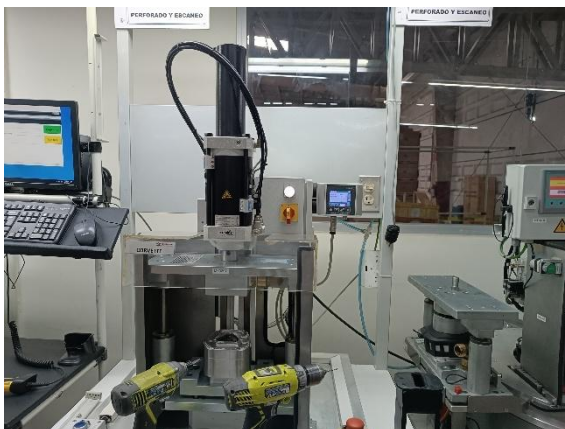
Ilustración 87 Puesto de perforado y escaneado antes
