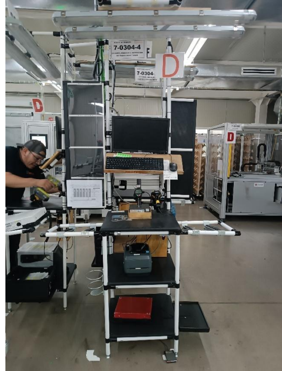
Ilustración 78 Puesto de escaneo, medición e inspección de piezas debilitas después
