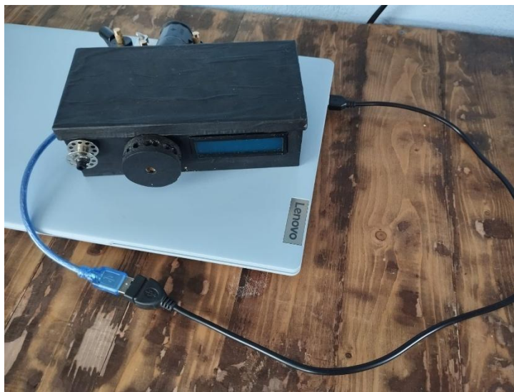
Figura 35 Conexión del prototipo rueda perforada a una laptop
