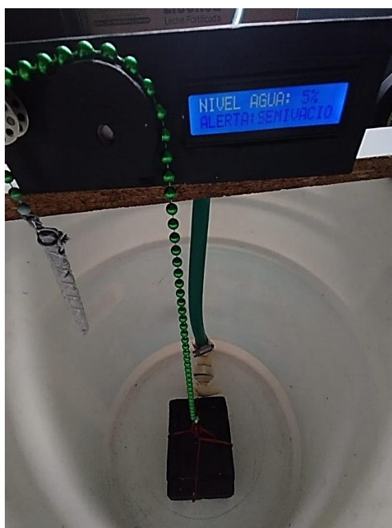
Figura 38 Mensaje de "Nivel de agua 5% y Alerta semivacio"
