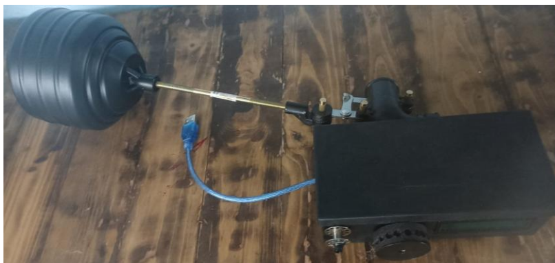
Figura 34. Flotador montado en el prototipo
