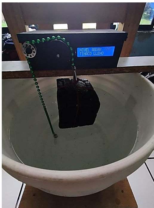
Figura 41 Mensaje de Nivel de agua 100% y tinaco lleno, con el prototipo montado en una silla
