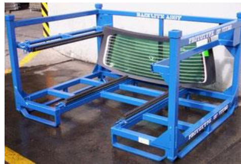
ILUSTRACIÓN 9 RACK METÁLICO PINTADO
