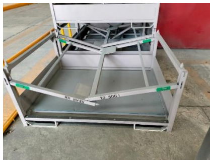
ILUSTRACIÓN 8 RACK SOLDADO Y CON PRIMER
