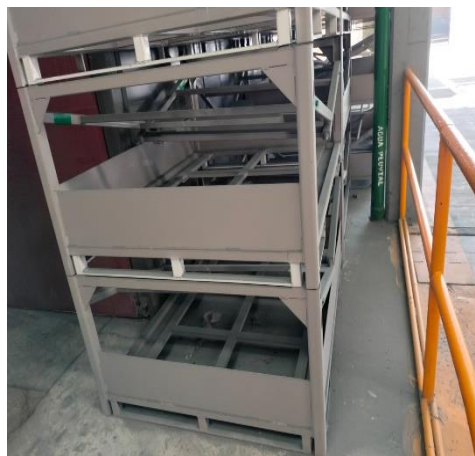
ILUSTRACIÓN 46 RACK CON PRIMER
