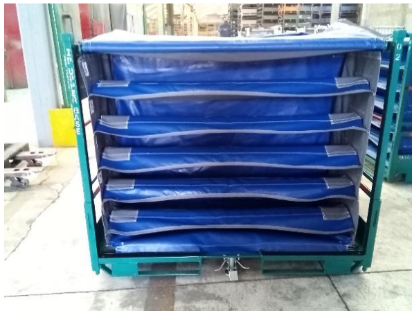
ILUSTRACIÓN 4 IMPLEMENTACIÓN DE LONA AZUL CON DUVETINA TYVECK TRICAPA
