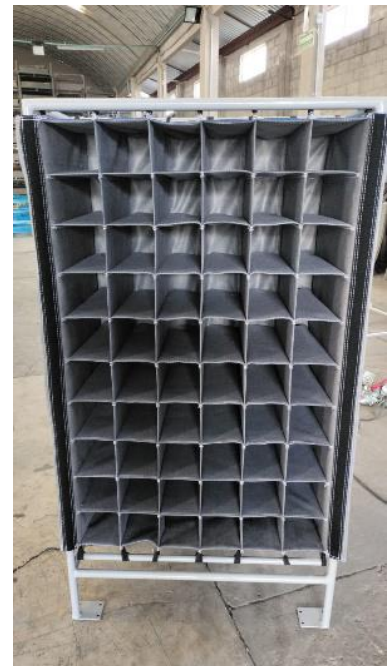
ILUSTRACIÓN 11 CELDADO TEXTIL MONTADO EN RACK METÁLICO
