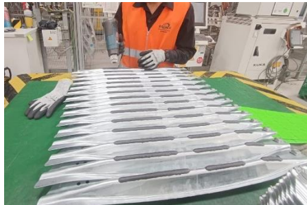
Ilustración 42: Retrabajo de barra de impacto 3013
