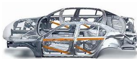
Ilustración 29: Análisis estructural de barras de impacto
