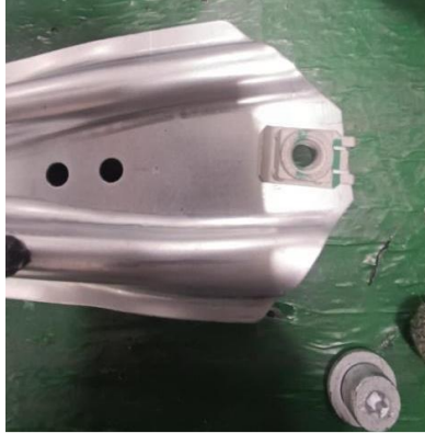
Ilustración 41: Validación de tuerca de barra de impacto
