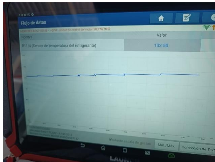
Ilustración 46. Monitoreo en estado de activación del ventilador y la temperatura del refrigerante
