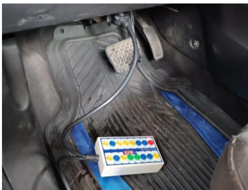
Ilustración 12. Protector conectado al OBD II del vehículo
