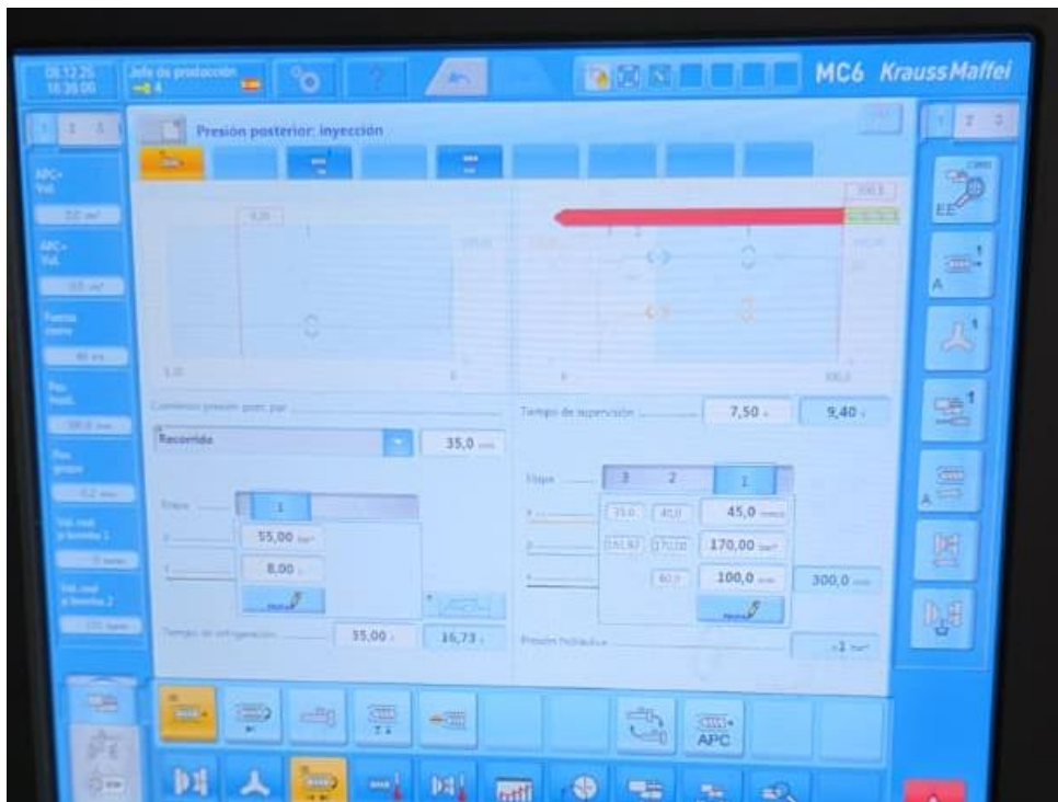
Ilustración 20 Parámetros del proceso de inyección
