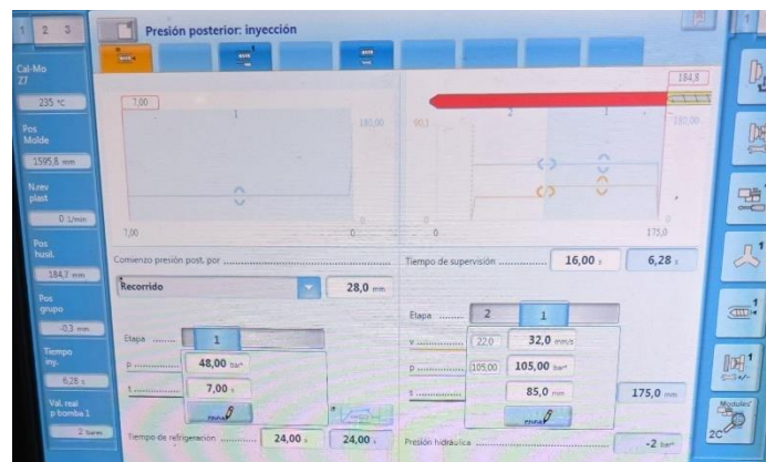
Ilustración 52 Parámetros con proceso modificado de NG-034
