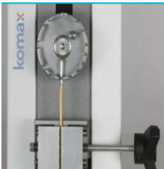
Imagen 26. Forma correcta para medir la fuerza de extracción
