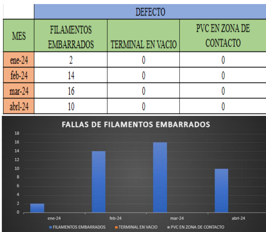
Imagen 13. Registro de fallas de terminales con filamentos embarrados por mes.
