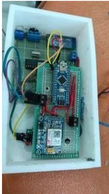
Ensamblaje del Circuito Electrónico en el Contenedor
