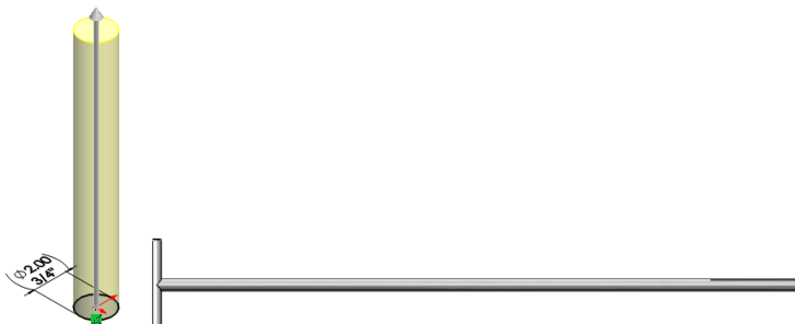
Figura 194 Elaboración de Bastón de Acero inoxidable
