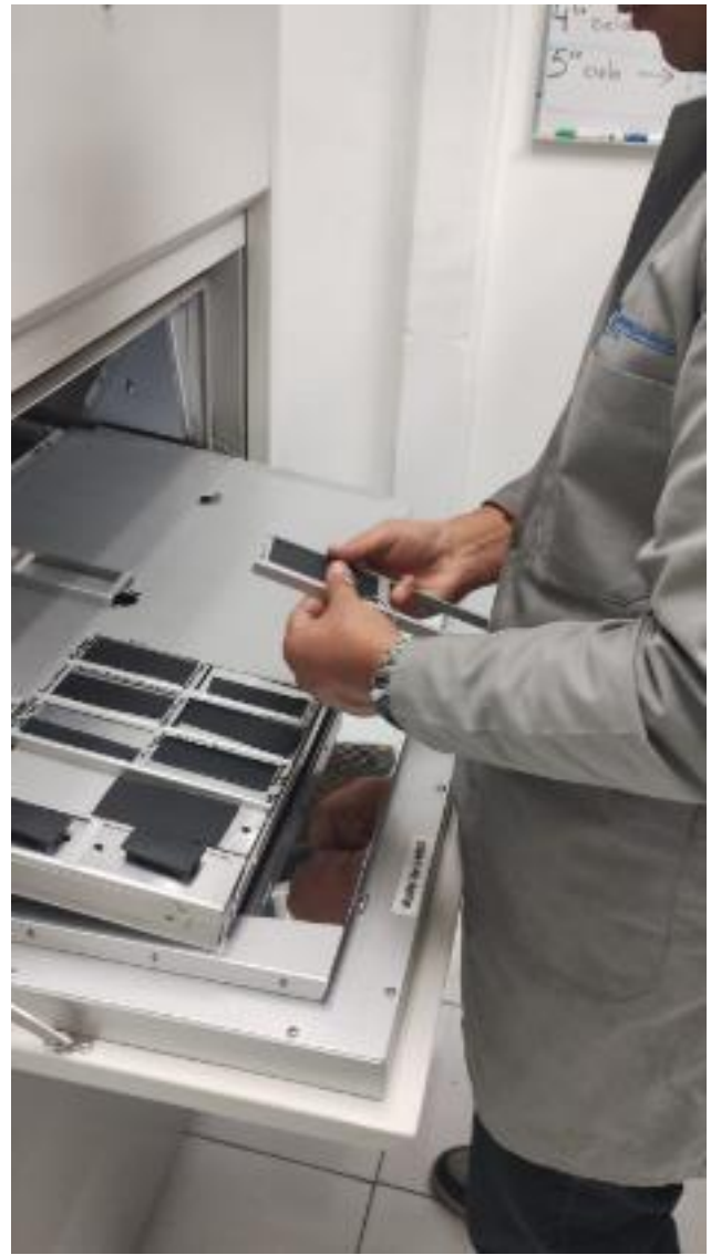
Preparación de probetas para prueba PV1303
