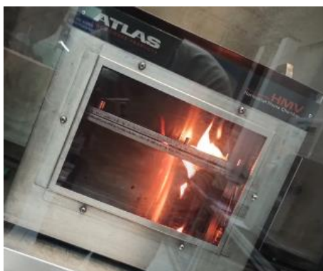
Recorrido de flama dentro de la cámara de fama.
