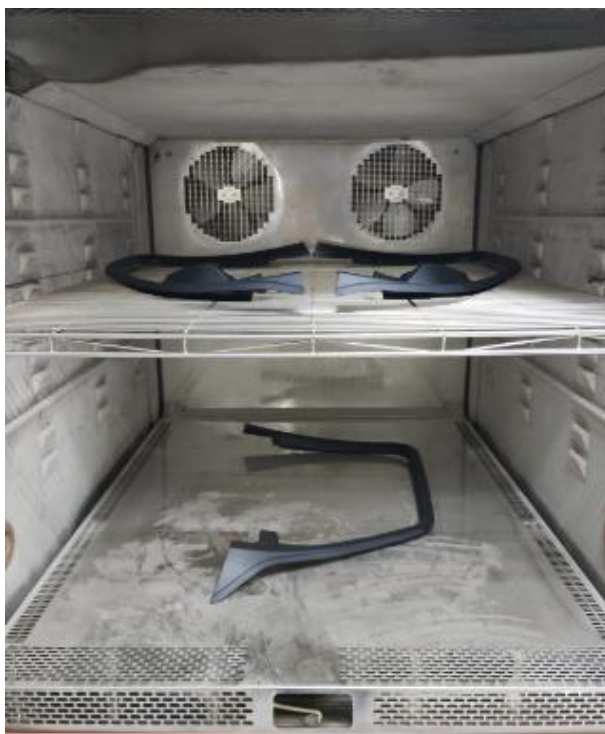
Marcos ventana Volkswagen después de ser sometidos a -40^{\circ}\text{C} durante 48hrs
