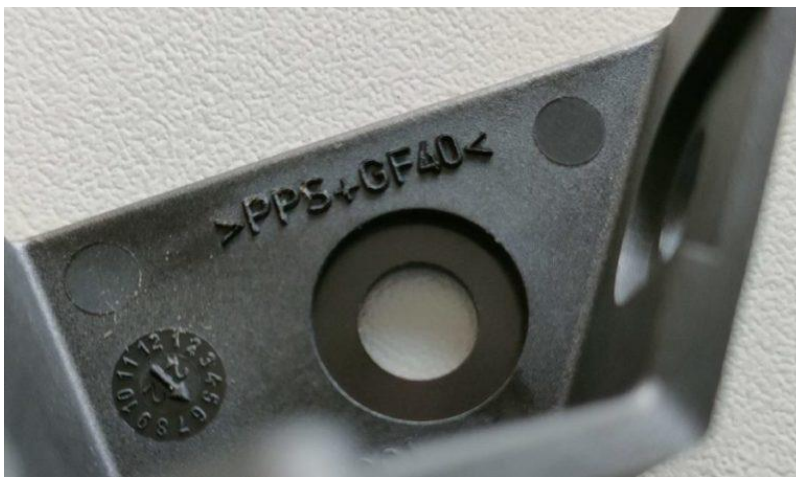
PPS con GF40 pieza soporte habitáculo.
