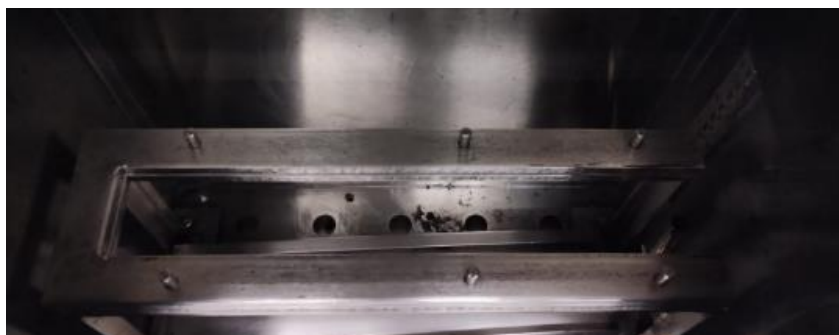
Bastidor para la colocación de probetas
