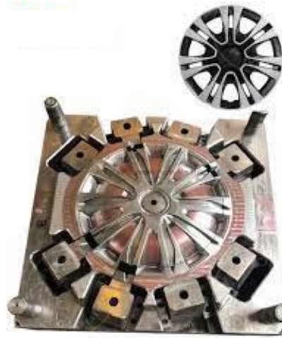
Molde para tapón automotriz (Propiedades exactitud para los requerimientos)
