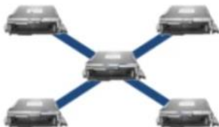
Imagen 2.30 Topología tipo estrella. Tomada de FlexRay Automotive Communication Bus Overview , [fotografía], NI, https://www.ni.com/en/shop/seamlessly-connect-to-third-party-devices-
