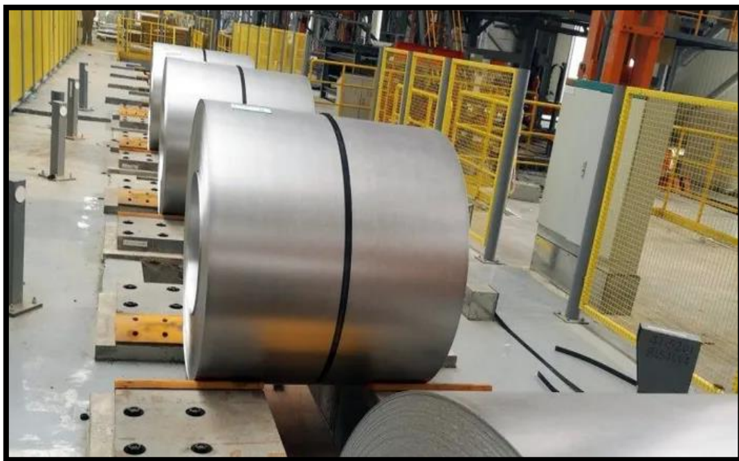
Ilustración 24 - Las bobinas de metal utilizadas para el estampado pueden ser de múltiples tamaños, materiales y grosores.
