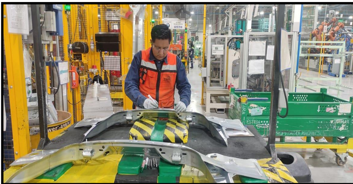
Ilustración 38 - Inspección del ensamblado final de Rear Cover (G42)
