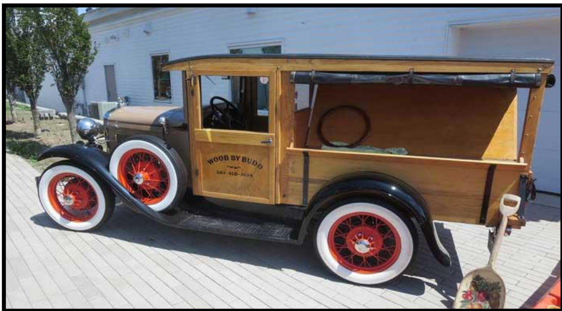
Ilustración 17 - Muchos de los primeros vehículos en la historia contaban con carrocería de madera
