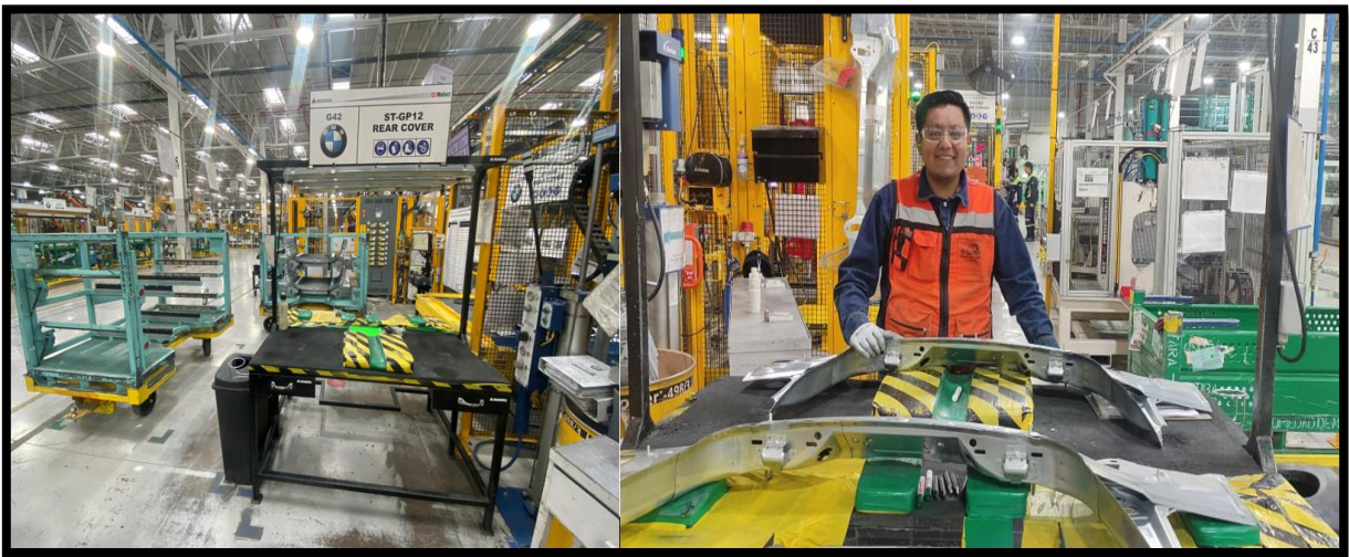
Ilustración 4 - Inspección de ensamble en ST - GP12 REAR COVER
