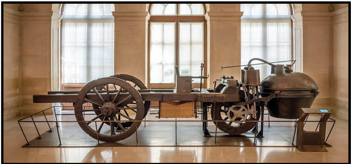
Ilustración 5 - El auto a vapor tenía el inconveniente de mantener la caldera caliente
