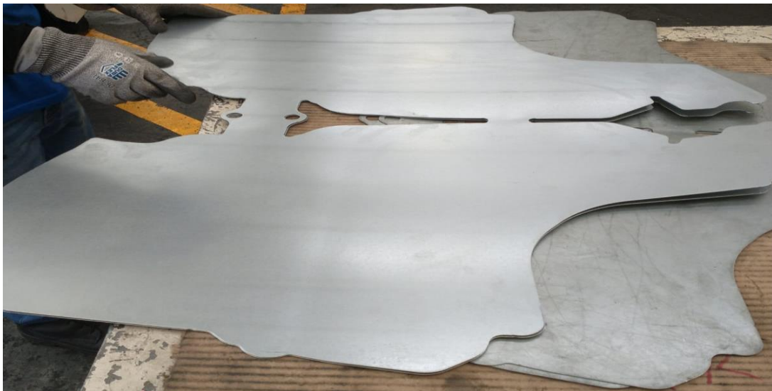
Ilustración 34. Comparación de pieza de inicio de corrida vs pieza master, INTEMEC S.A DE C.V.
