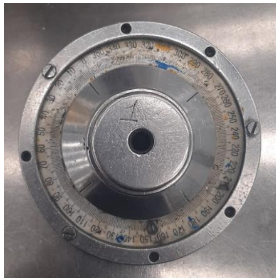
Figura 4.22 Dispositivo de Calibración con Escala dañada
