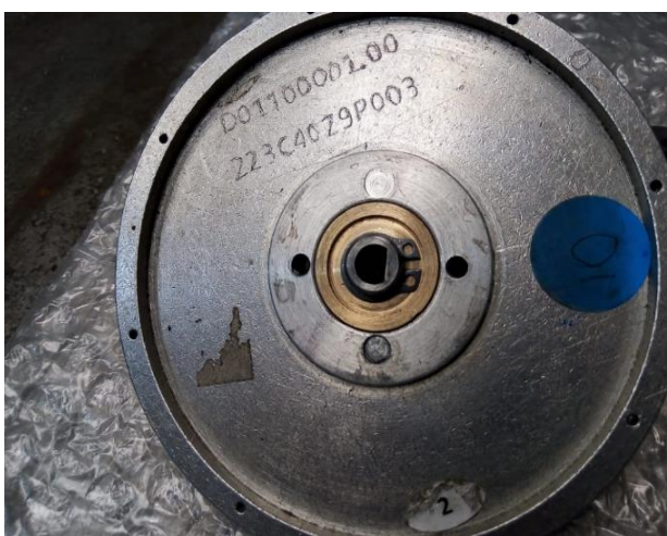
Figura 4.24 Dispositivo con un Nuevo Centro
