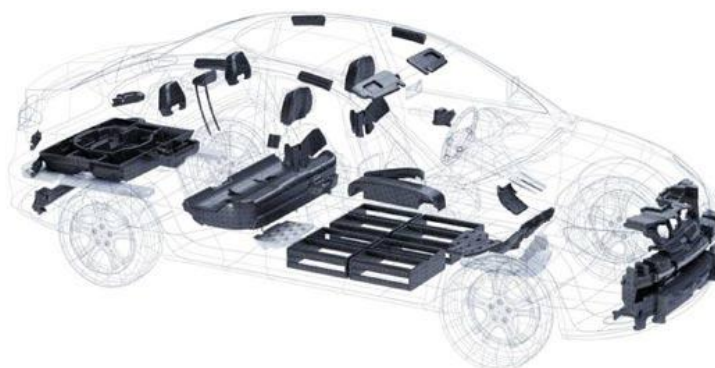
Figura 1.1.1. Componentes de foam moldeada en la industria automotriz
