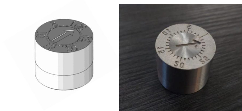
Figura 3.3.3 Contraste entre el modelo CAD (izquierda) y la pieza física mecanizada (derecha) del fechador móvil.
