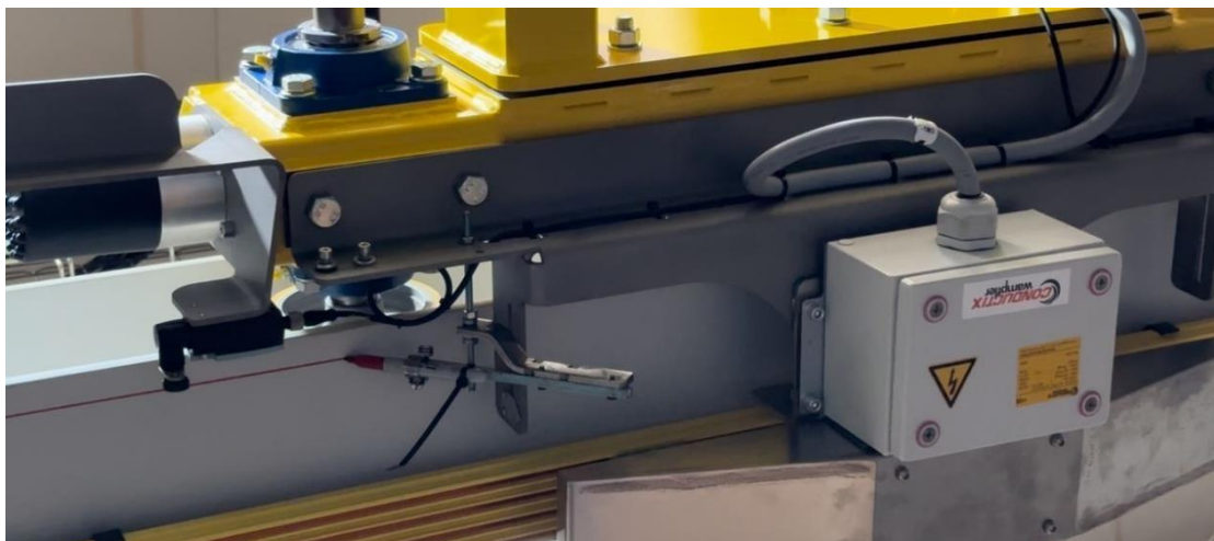
Imagen 7.4 En esta imagen se puede observar el componente mecánico y el plumón sujetos de tal manera que van marcando la línea guía de color rojo para que de esta manera se coloque la cinta de código de barras de una forma correcta y precisa.
