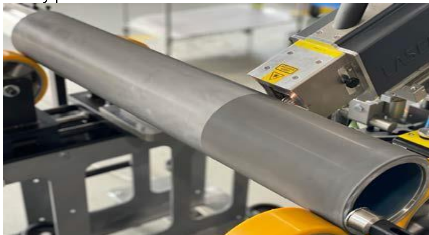
Imagen c.S.1 Rodillo Anilox (limpio lado izquierdo-sucio lado derecho). Laserclean B.V,2021. Limpieza eficiente por láser para anilox de alta calidad de impresión.
