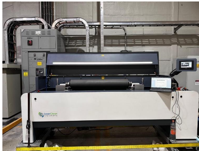
Imagen 7.33 En la imagen podemos observar un anilox dentro de la maquina el cual es mas grande y un diámetro mayor, por lo que es un anilox de banda ancha.
