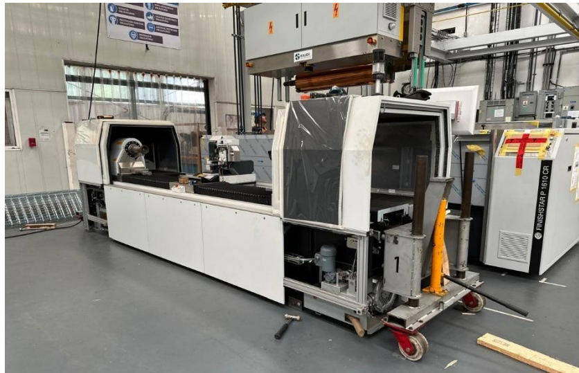
Imagen 7.22 Como se puede mostrar en la imagen se observa la grabadora k500 (1) colocada en posición alineada con la grúa, por lo que se deben nivelar de acuerdo con el nivel de precisión ya que son equipos muy precisos
