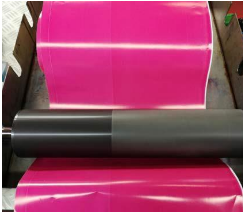
Imagen c.14.1 Limpieza Química ( izq ) VS limpieza láser ( der ). Note la alta densidad de color que obtiene la limpieza con láser, usando los exactos mismos parámetros en la máquina de impresión. Laserclean B.V, 2021. Limpieza eficiente por láser para anilox de alta calidad de impresión.
