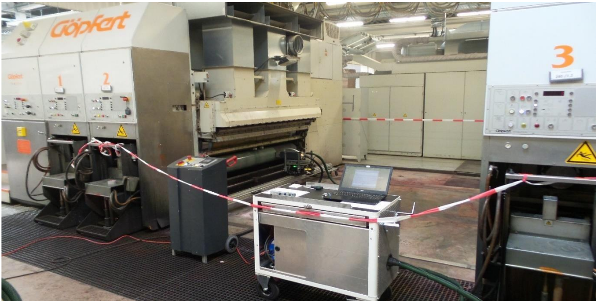
Imagen c.4.3 Configuración completa de limpieza laser en línea. LASERCLAEN,2020. Installation, operation and maintenance.
