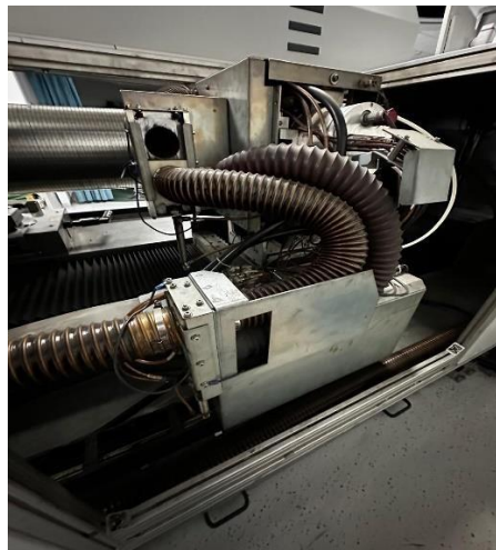
Imagen 7.1 Aquí se pueden apreciar algunos componentes traseros de la S1300, como tubería de succión, componente de riel de movilidad hacia la izquierda y derecha, componentes hidráulicos, neumáticos y eléctricos.
