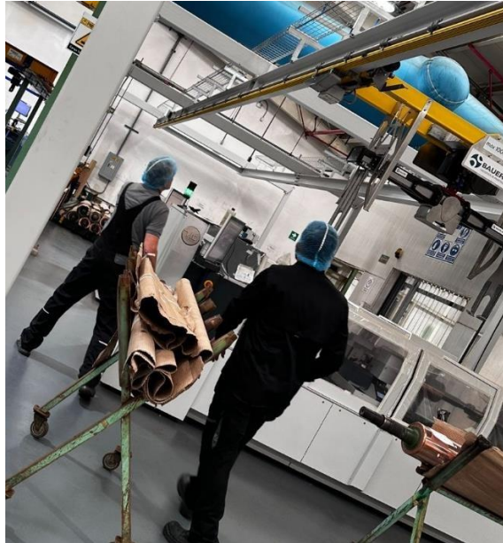
Imagen 7.3 Como se puede observar del lado derecho superior se encuentra la grúa wega la cual se encarga de mover los cilindros de una maquina a otra.
