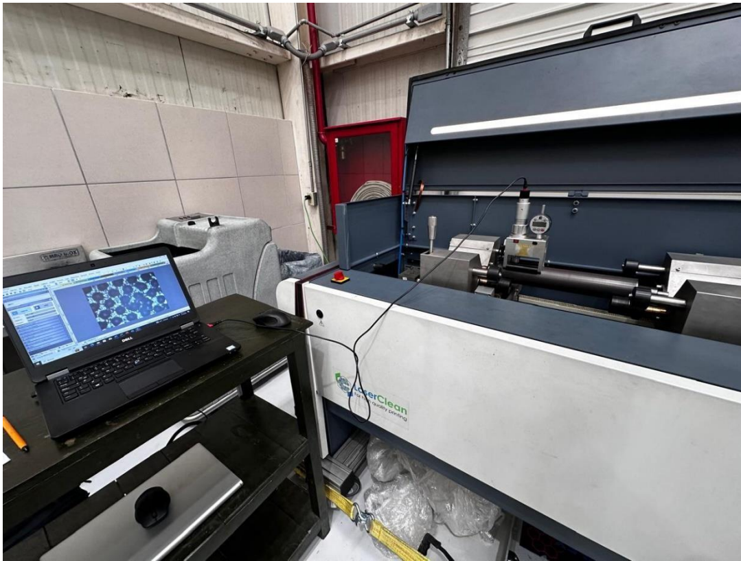
Imagen 7.31 Como se puede observar en la imagen del lado izquierdo una laptop la cual la utilizamos en conjunto de un microscopio digital para observar el anilox y el tamaño de grabado que tiene también llamadas LPI (Linaje Por Pulgada) como se puede observar en la laptop el tipo de grabado del anilox.
