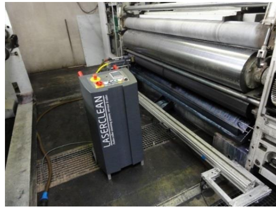
Imagen c.4.2 Unidad laser para limpieza en línea
