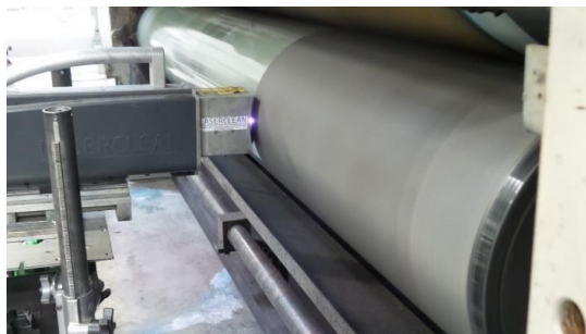
Imagen c.1 Limpieza láser móvil (en línea o en la imprenta). Mr. Martin de Wit, 2021. The Cleaning of Anilox Ceramic Rollers by means of Laser
