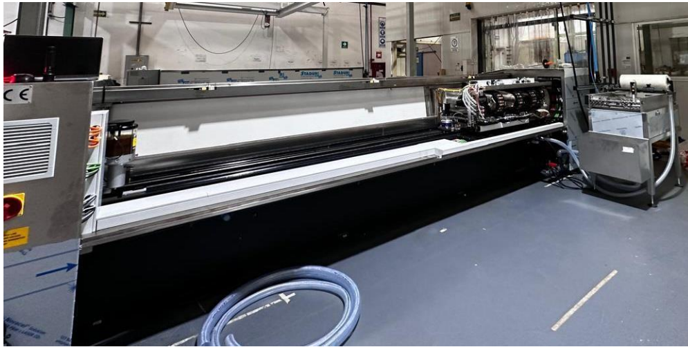
Imagen 7.20 Como se observa en la maquina CFM se encuentra nivelada, conectada y con la revisión general previa, para comenzar a hacer pruebas de trabajo.
