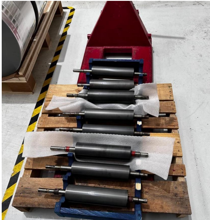
Imagen 7.32 En esta imagen se pueden observar los anilox a limpiar en este caso son de banda angosta.
