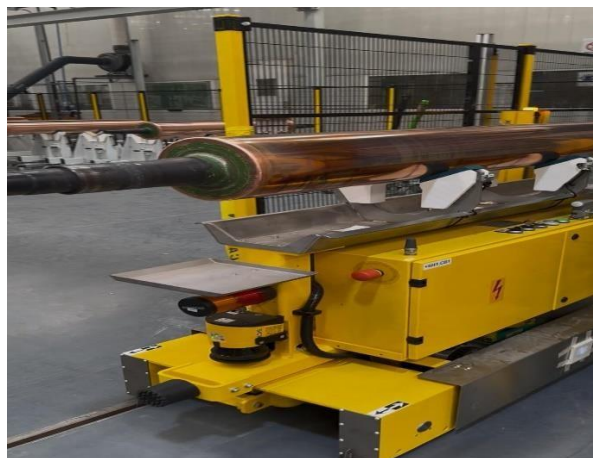
Imagen 7.2S En la imagen se puede observar el shuttle el cual trasporta los cilindros del aérea de grabado hacia el almacén.
