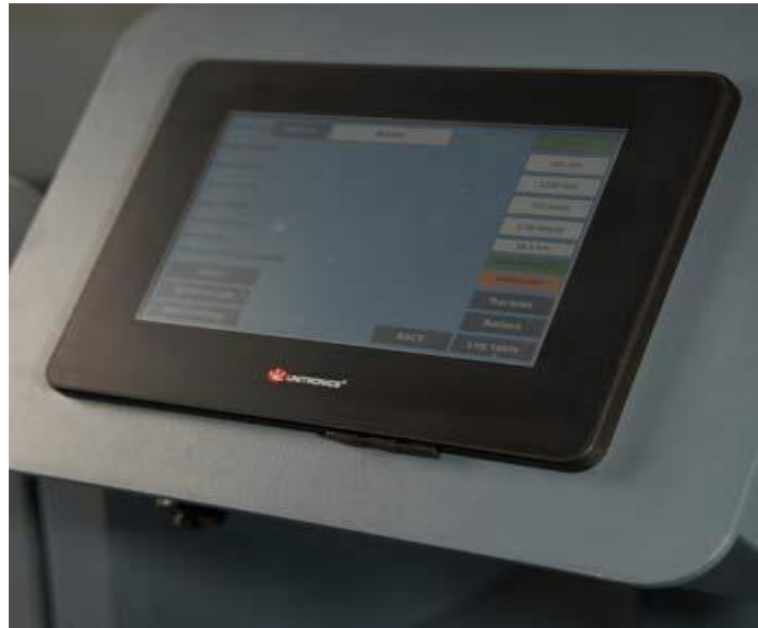
Imagen c.17.1 Pantalla táctil del equipo donde se colocan todos los parámetros necesarios para realizar una limpieza correcta. Laserclean B.V,2021. Limpieza eficiente por láser para anilox de alta calidad de impresión.
