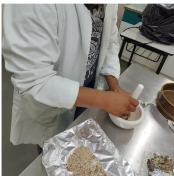
Ilustración 3.2 Uso de mortero para moler la semilla de mango
