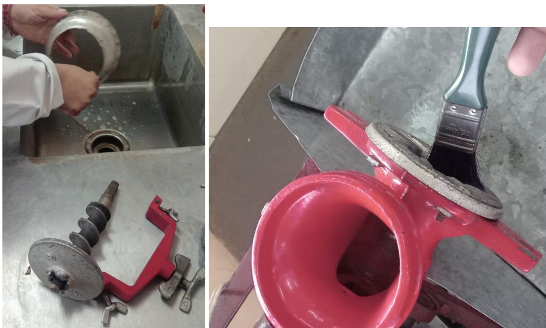
Figura 12 desmontaje y lavado de equipo de trituración
