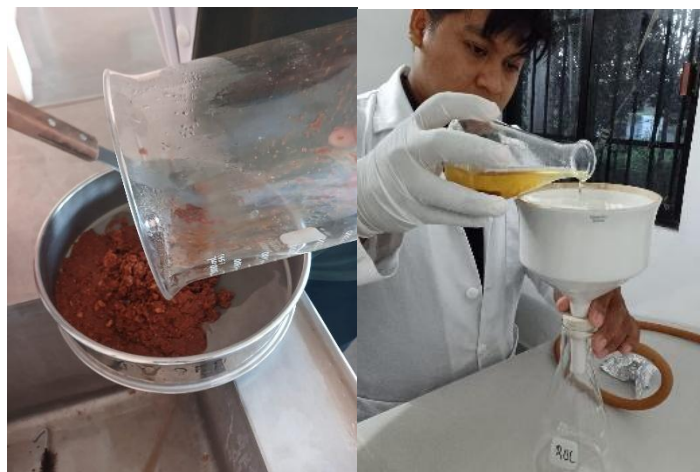
Figura 17 filtración con malla #200 y Bomba de vacío
