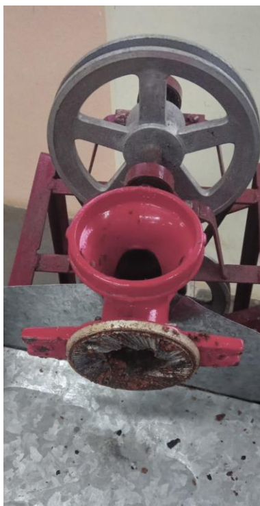
Figura 13 demoledora (trituration de semilla) partícula de aproximadamente 1-5 mm.
