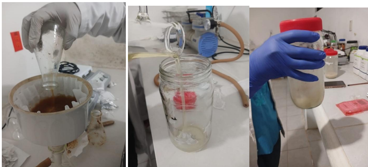
Figura 21 Proceso de filtración por medio de bomba de vacío para obtener suero y separar los residuos homogéneo
