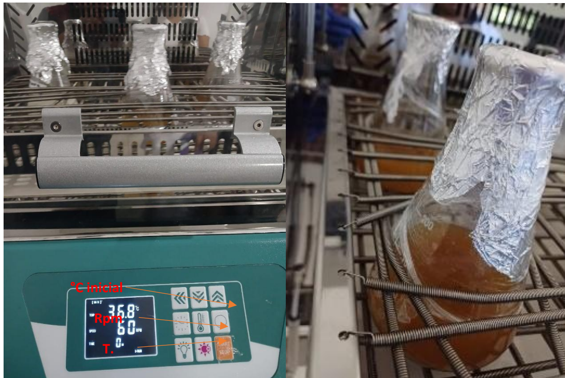
Figura 19 La fermentación se realizó por triplicado para cada cepa en una incubadora con agitación Zhicheng ZHWY-200B a (t) inicial de 36.8 °C con una agitación de 60 rpm.
