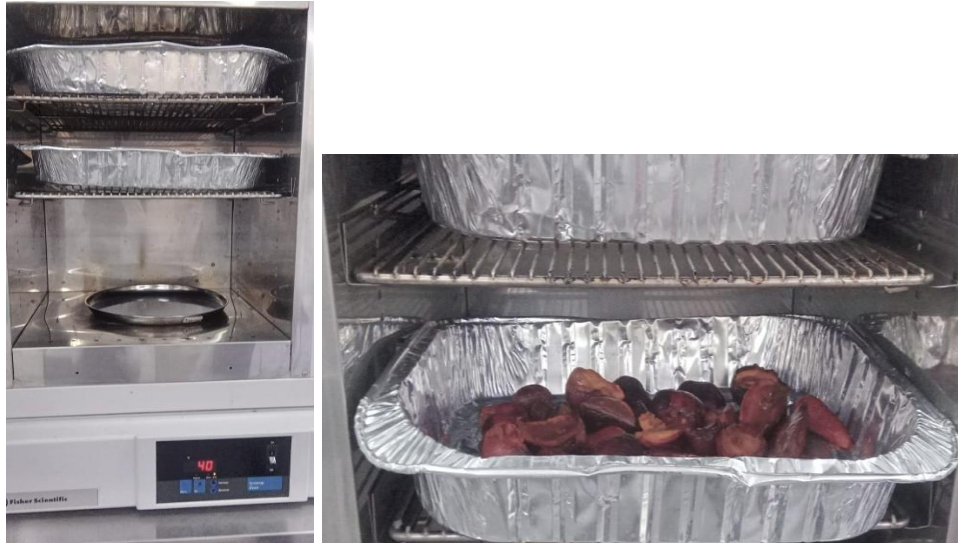
Figura 11 secado de las semillas en horno de secado de la marca Novatech, NOT-HS35-AID
